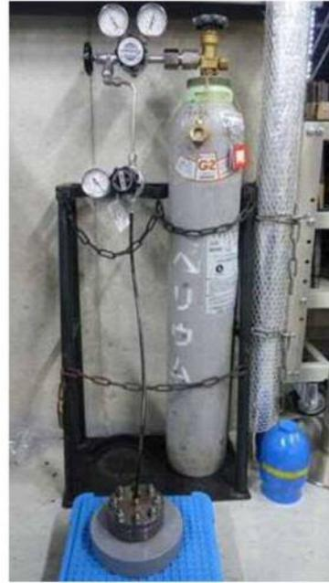
第13図 He気密確認試験状況
