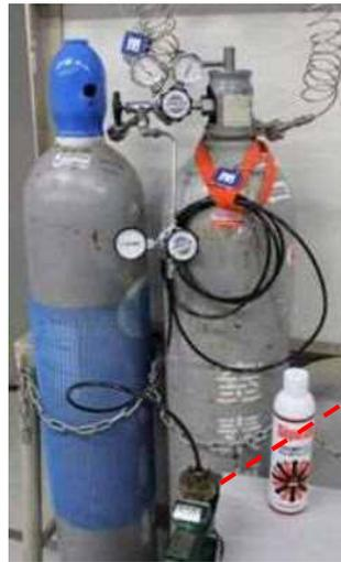
第5図 気密確認試験状況
