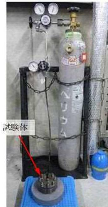
第5図 He気密確認試験状況
