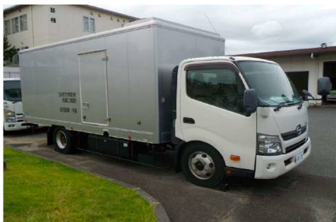
可搬型代替交流電源設備
