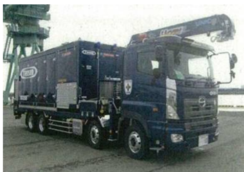
可搬型代替注水大型ポンプ
