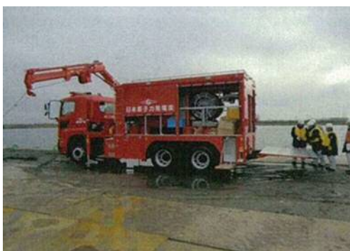
可搬型代替注水中型ポンプ
