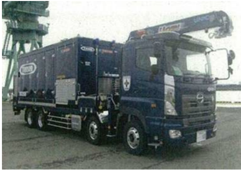
可搬型代替注水大型ポンプ
