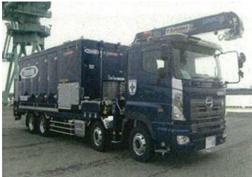
可搬型代替注水大型ポンプ
