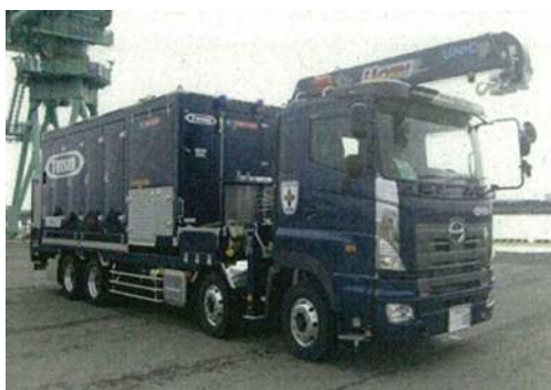
可搬型代替注水大型ポンプ
