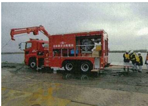
可搬型代替注水中型ポンプ
