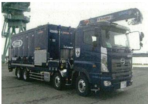
可搬型代替注水大型ポンプ
