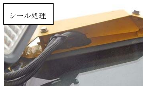
第1図 可搬型設備 小動物対策例 (2/2)
