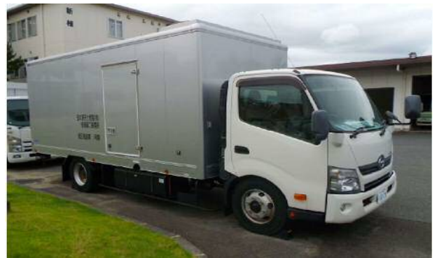
可搬型代替低圧電源車
