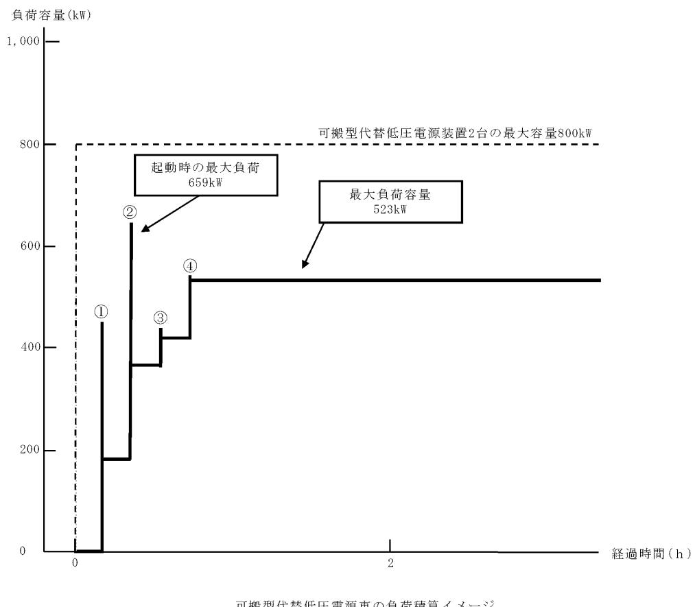
図 3-8 代替所内電気設備への給電時の負荷積算イメージ
