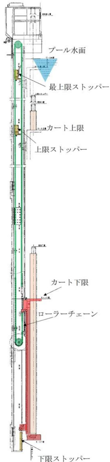
第9図 チャンネル着脱機の概略図
