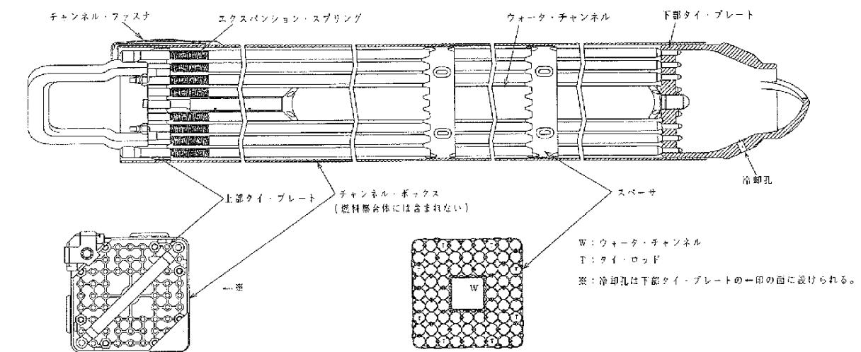
第 13.2 図 燃料集合体の概要 (9 × 9 燃料 (B型))
