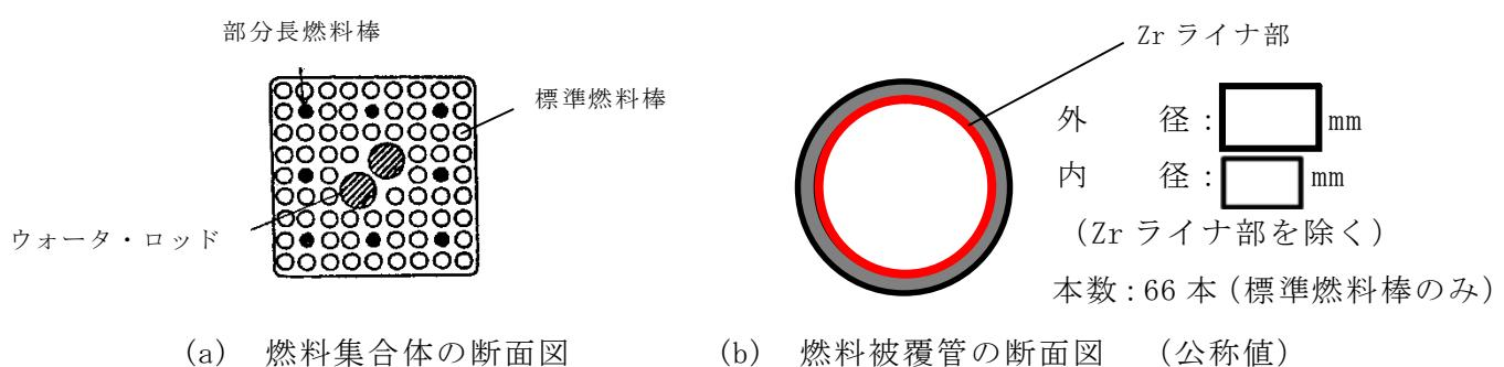
第 17 図 燃料集合体の断面図
