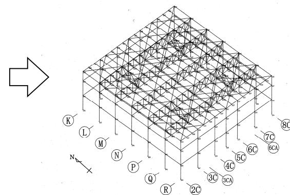
第10図 原子炉建屋屋根評価モデル
