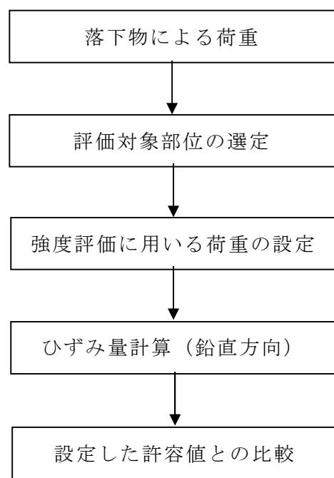
第 14 図 燃料集合体の強度評価フロー
