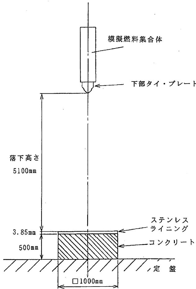
図 1 模擬燃料集合体落下試験方法
