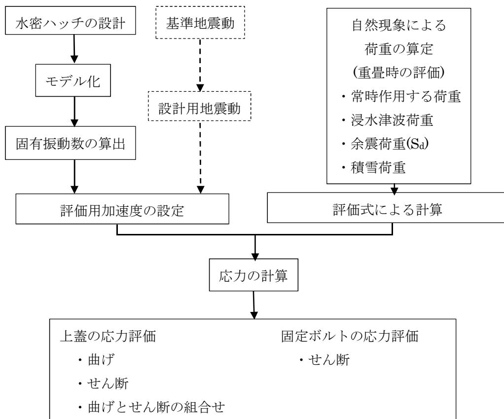
図2 水密ハッチの強度評価フロー
