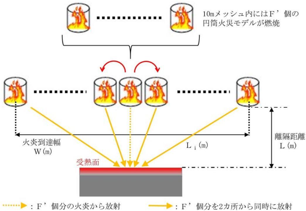
図 2.1.1-3 円筒火炎モデルの概念図
