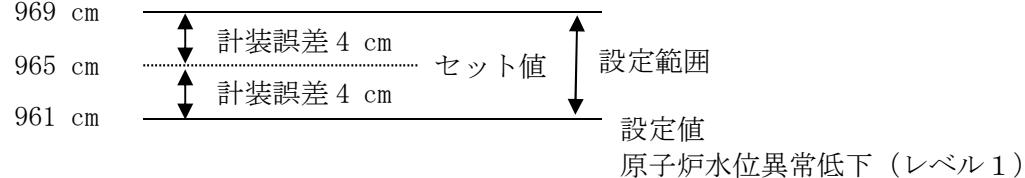
原子炉水位異常低下（レベル1）設定値の概要図
