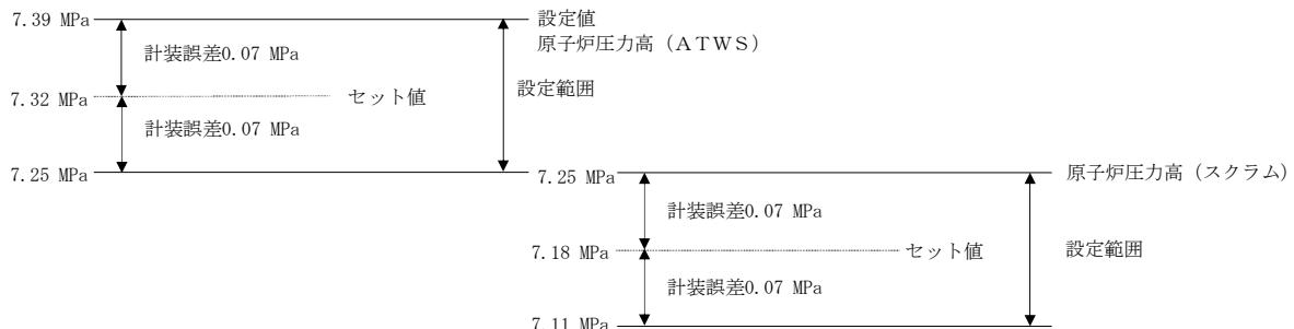
原子炉圧力高（A TWS）設定値の概要図
