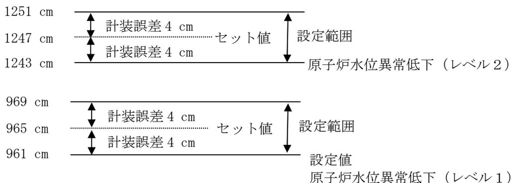
原子炉水位異常低下（レベル1）設定値の概要図
