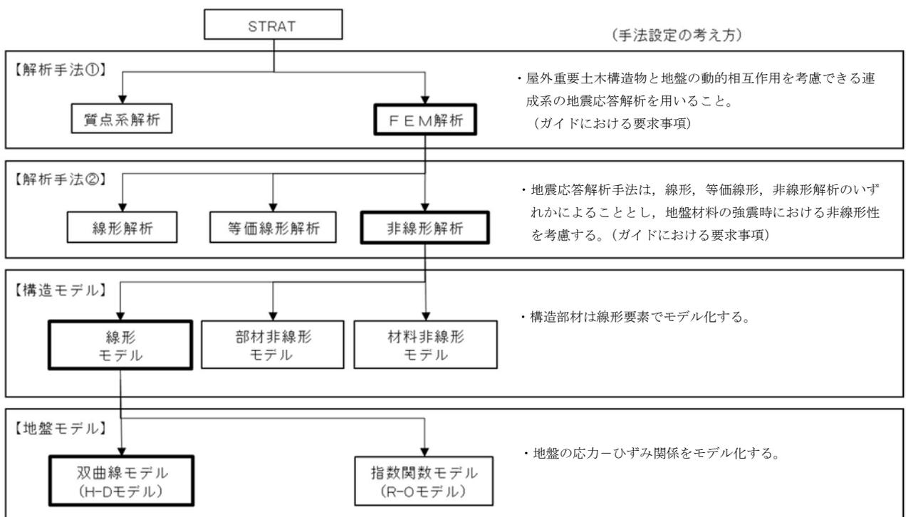
図3.2-9 地震応答解析手法の選定フロー
