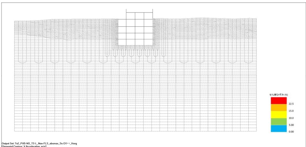
図 1.10-5 (1) 南北方向⑤-⑤断面の最大せん断ひずみ分布 (Ss-D1 (H+, V+))
