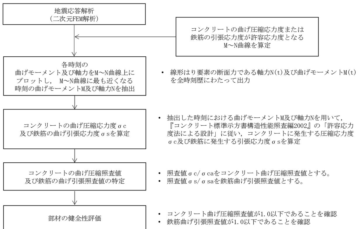
図 1.10-10 (2) コンクリート曲げ照査及び鉄筋曲げ照査フロー
