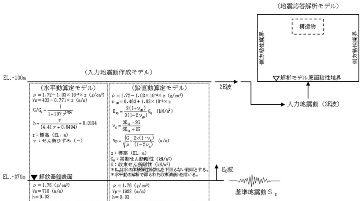
図 3.3-1 入力地震動算定の概念図
