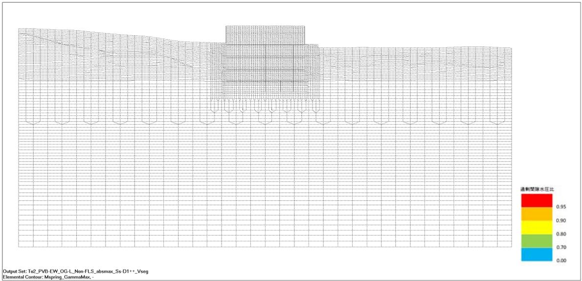
図 1.10-9 (1) 東西方向断面の過剰間隙水圧比分布 (Ss-D 1 (H+, V+))
