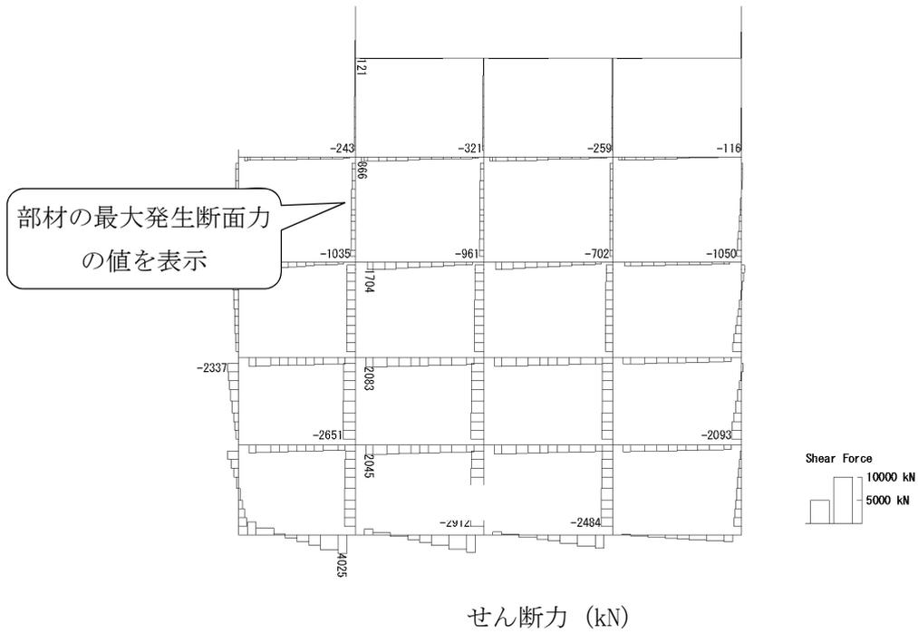
図 1.10-3 (2) S<sub>s</sub>-D1 (H+, V+) において最も厳しい照査値における断面力 (t=00.00s)
