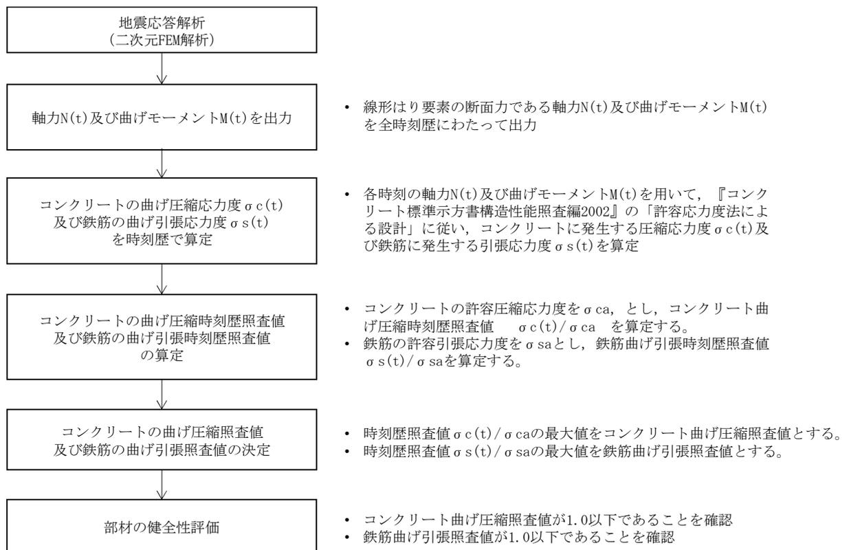
図 1.10-10 (1) コンクリート曲げ照査及び鉄筋曲げ照査フロー (時刻歴照査)
