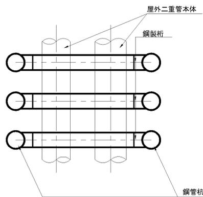
図 3.2-3 屋外二重管基礎の平面図
