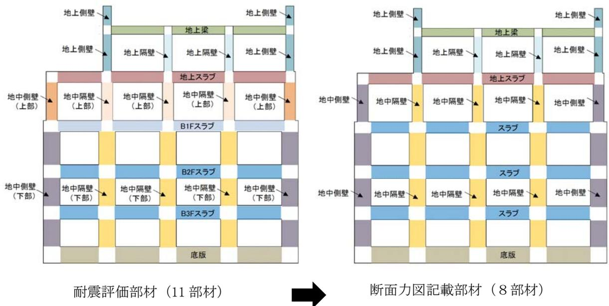
図 1.10-1 断面力図記載用の部材グループ分け（常設代替高圧電源装置置場）
