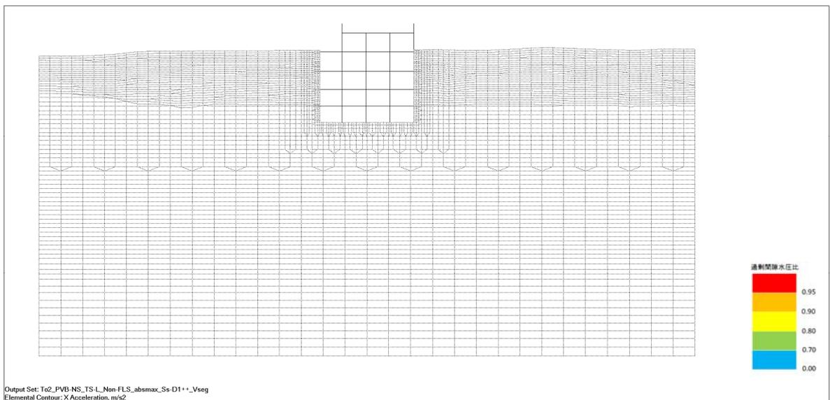
図 1.10-8 (1) 南北方向⑤－⑤断面の過剰間隙水圧比分布（ $S_s-D1(H+, V+)$ ）
