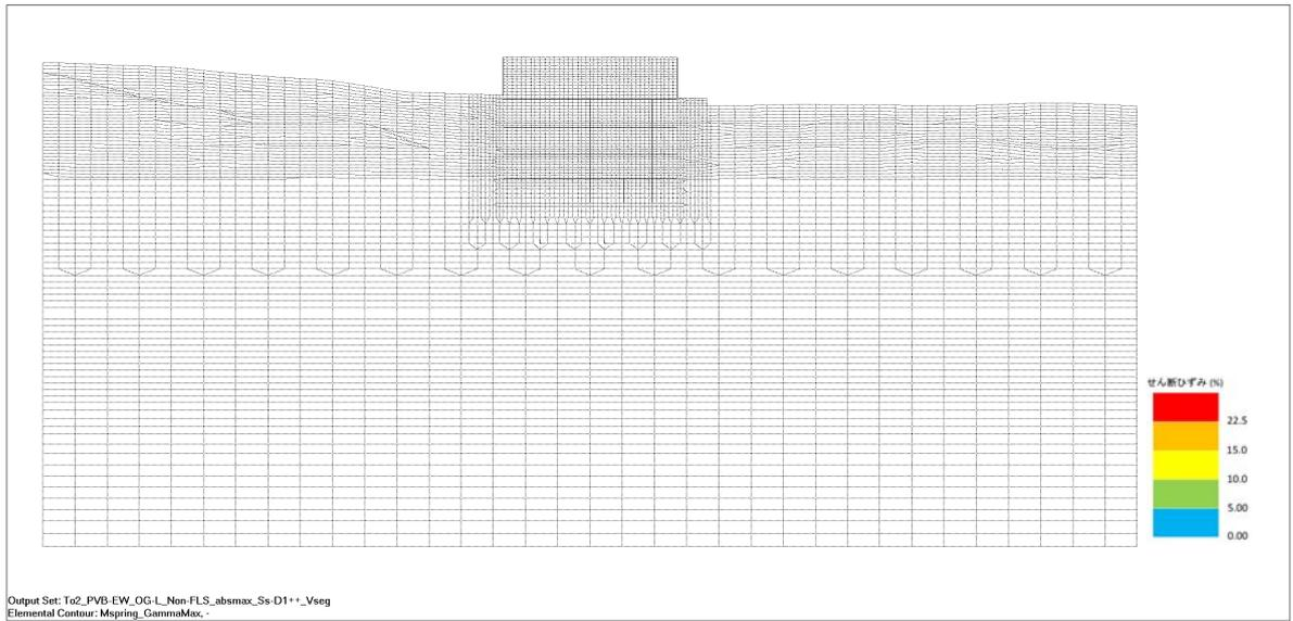
図 1.10-6 (1) 東西方向断面の最大せん断ひずみ分布 (S<sub>s</sub>-D 1 (H+, V+))
