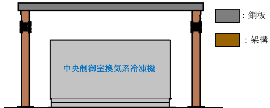
図1 防護対策施設
