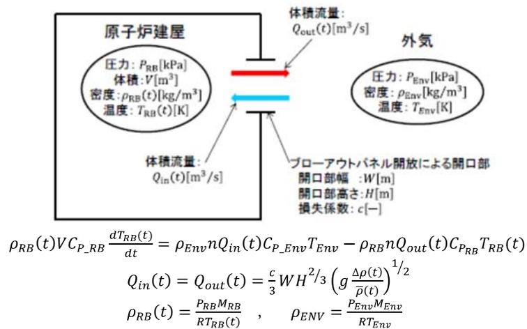
図2 温度評価モデルのイメージ
