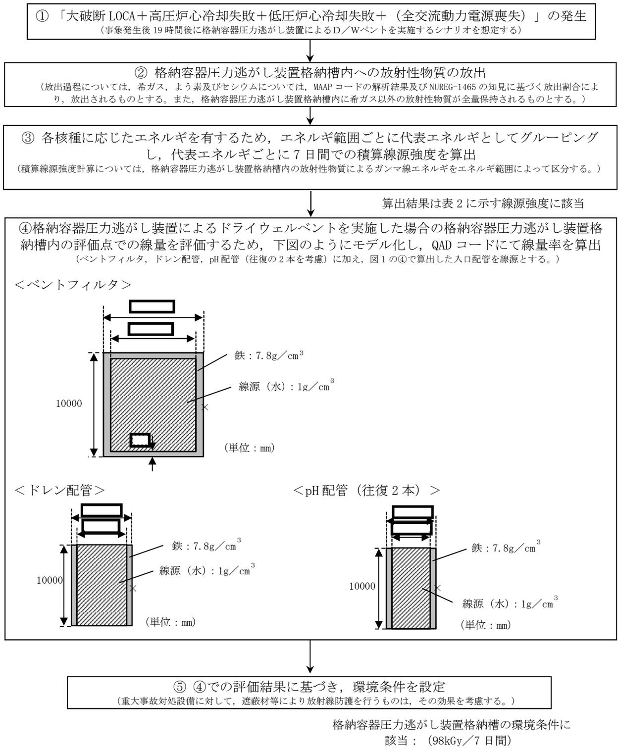
図3 重大事故時における格納容器圧力逃がし装置格納槽内の線源付近の重大事故等対処設備に対する環境条件設定のフロー図
