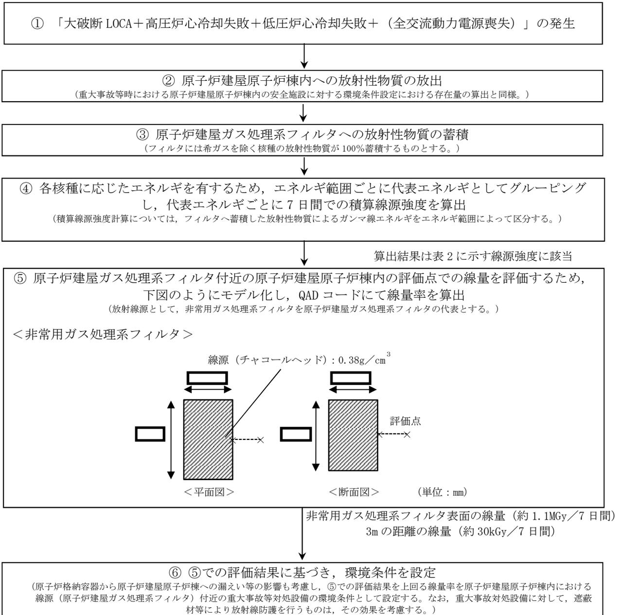
原子炉建屋原子炉棟内における線源 (原子炉建屋ガス処理系フィルタ) 付近の環境条件に該当
