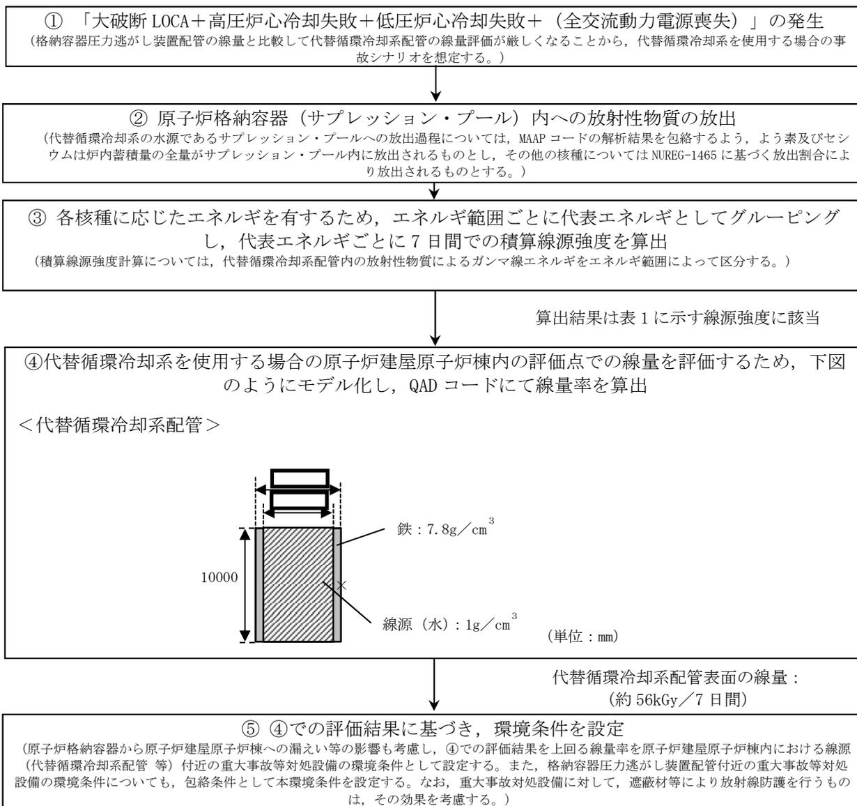
原子炉建屋付原子炉棟内における線源 (代替循環冷却系配管) 付近の環境条件に該当 (原子炉建屋ガス処理系フィルタ付近の設備を除く) :
