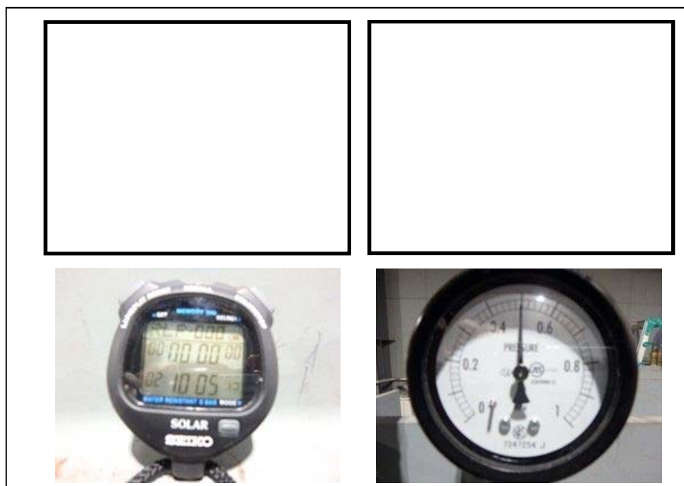
図 5.13.2.2-19 0.50 MPa 10 分経過後(漏えい無し)
