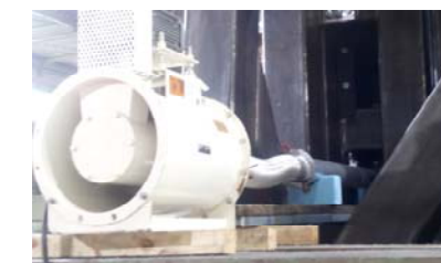
第3図 排風機及び風速計設置状況
