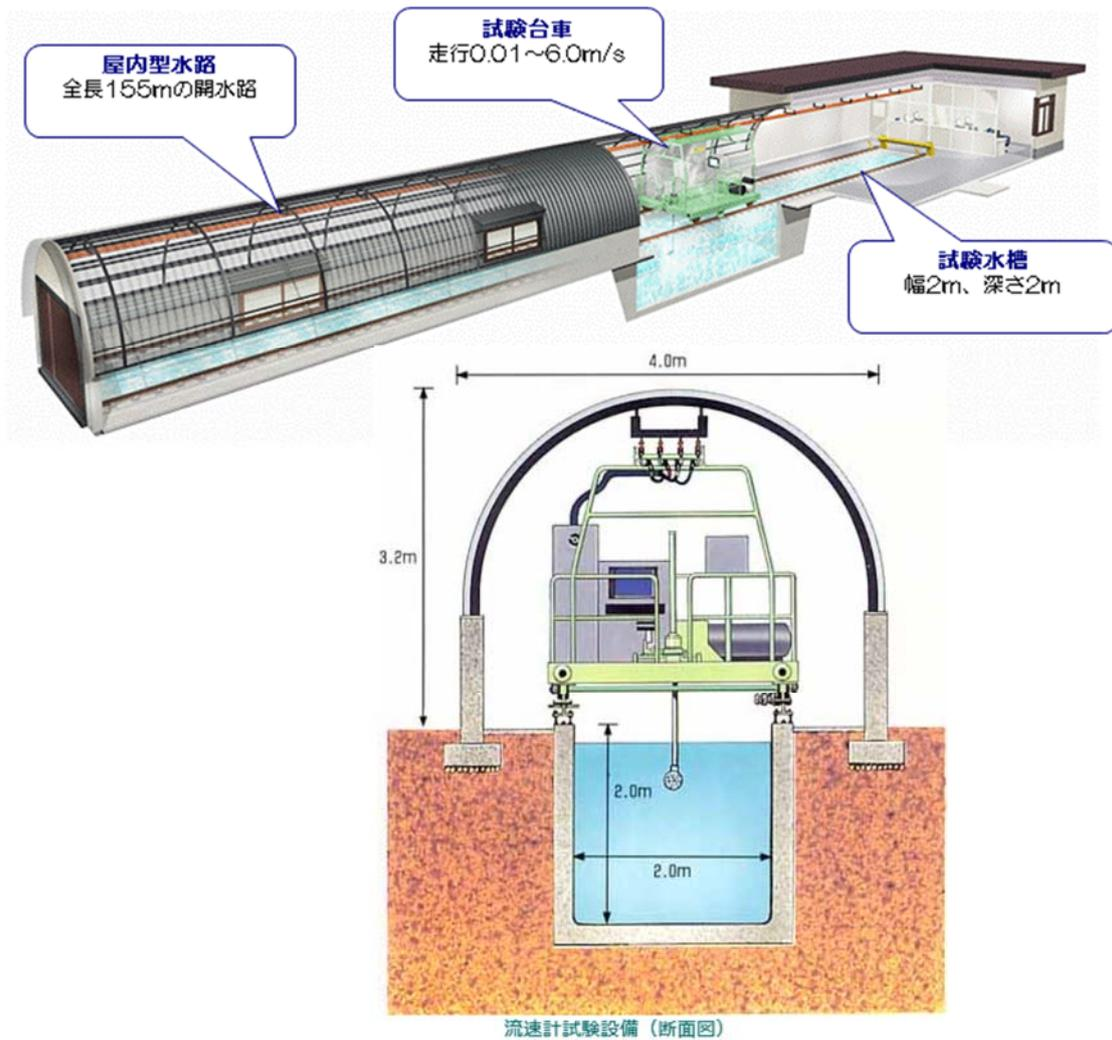
第1図 流速計試験所の概要図
