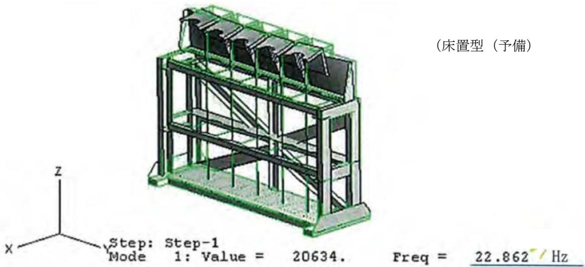
図 4.5-3 非常用窒素供給系高圧窒素ポンプユニットの振動モード図
