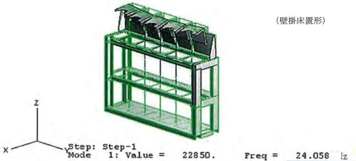
図 5.5-3 中央制御室退避室 空気ポンベユニットの振動モード図
