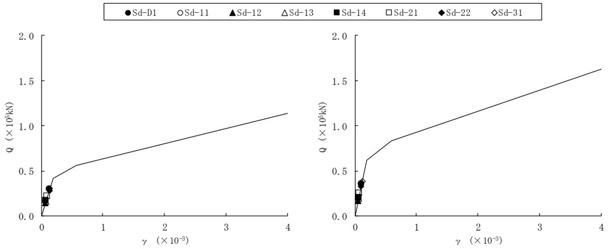
図4-28 (1/2) せん断スケルトンカーブ上の最大応答値 ( $S_a$ , EW 方向)
