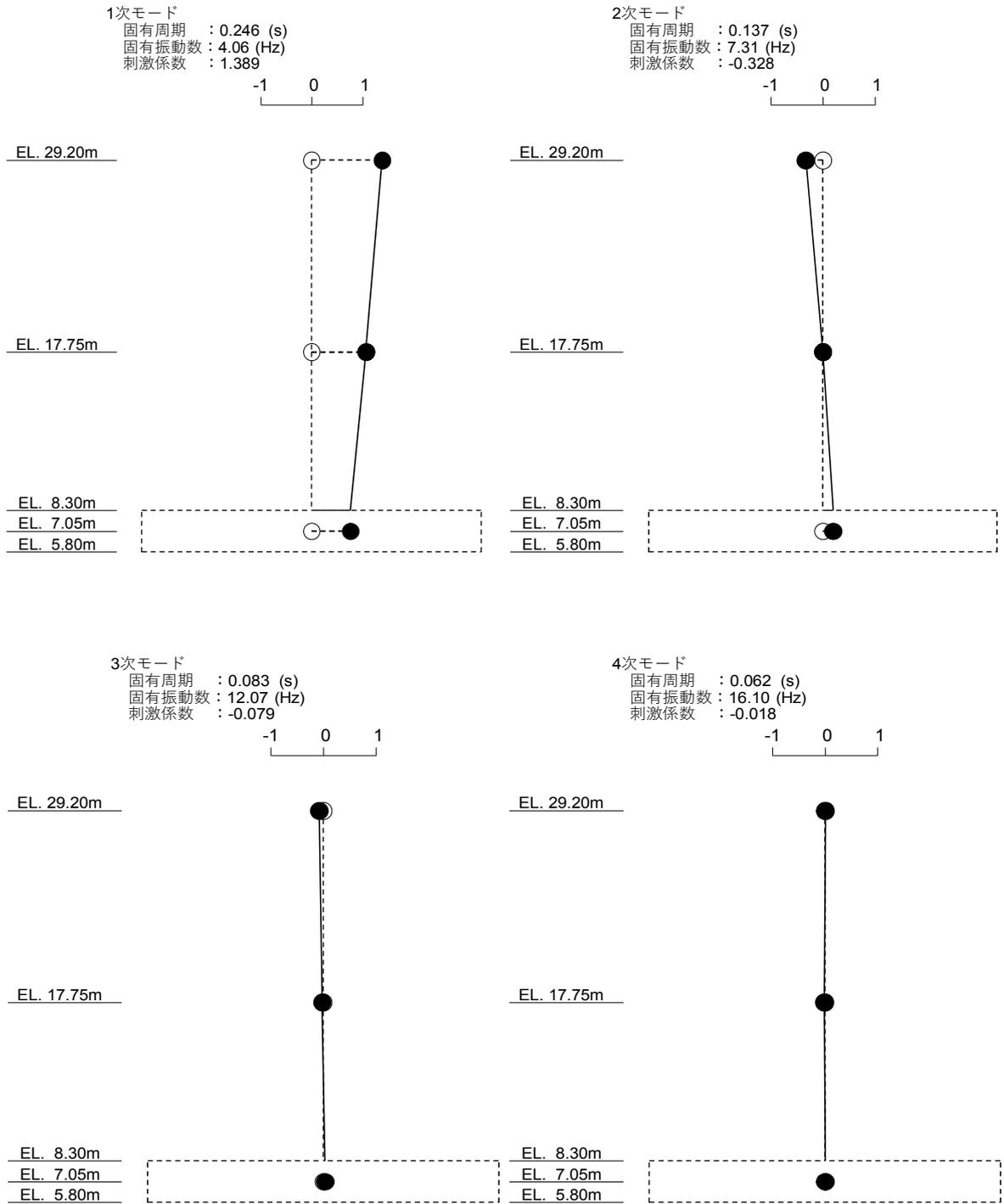
図4-2 (1/3) 刺激関数図 (S<sub>d</sub>-D1, NS方向)
