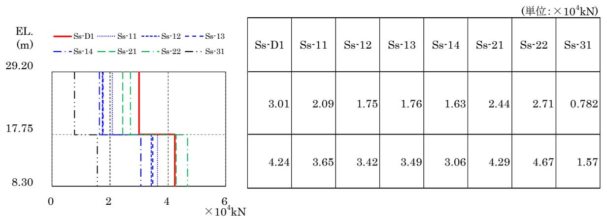
図 4-13 最大応答軸力 ( $S_s$ , UD 方向)
