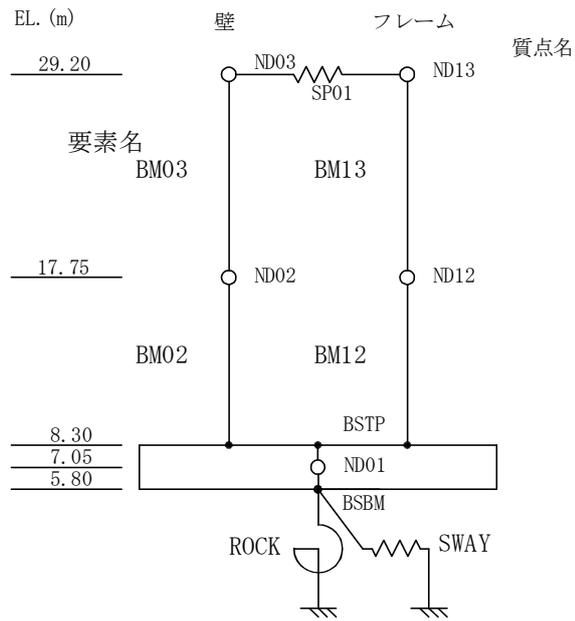
図 3-2 地震応答解析モデル (EW 方向)
