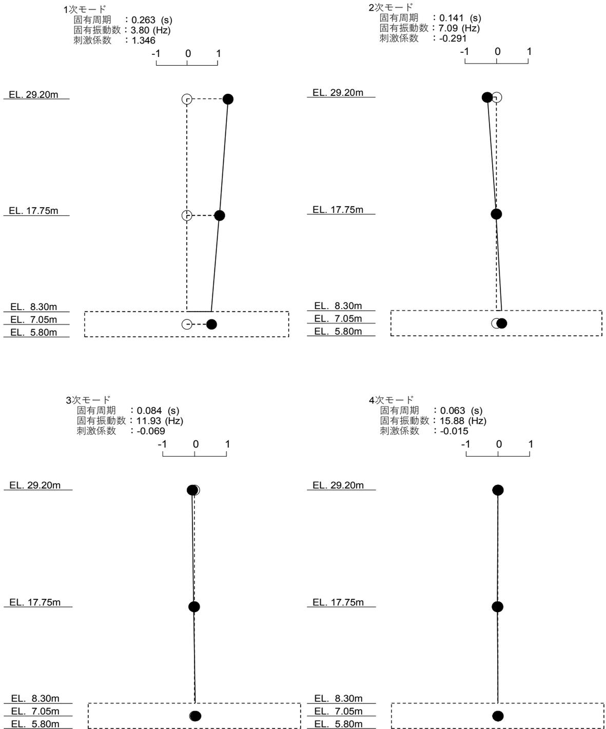
図4-1 (1/3) 刺激関数図 (S<sub>s</sub>-D1, NS方向)
