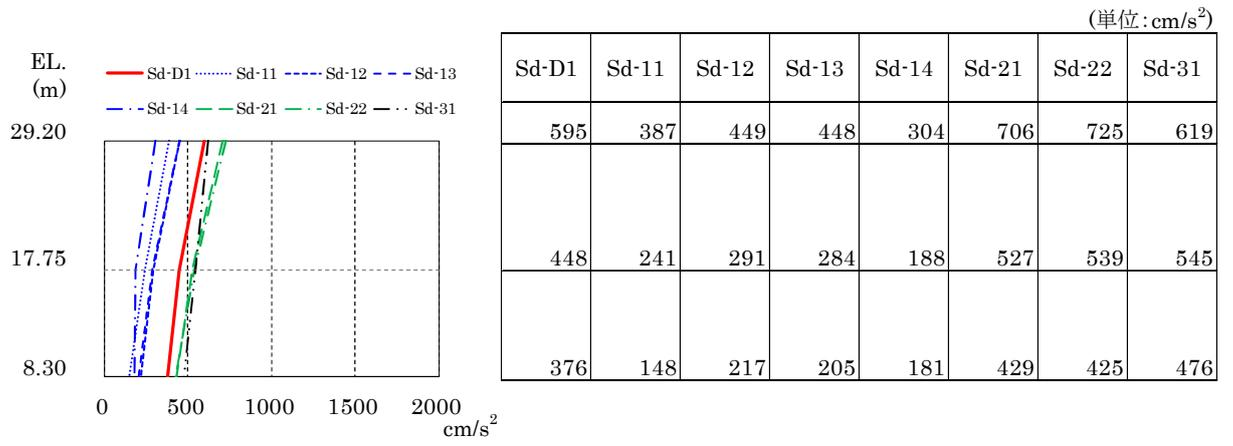
图 4-16 最大応答加速度 (S<sub>d</sub>, NS 方向)
