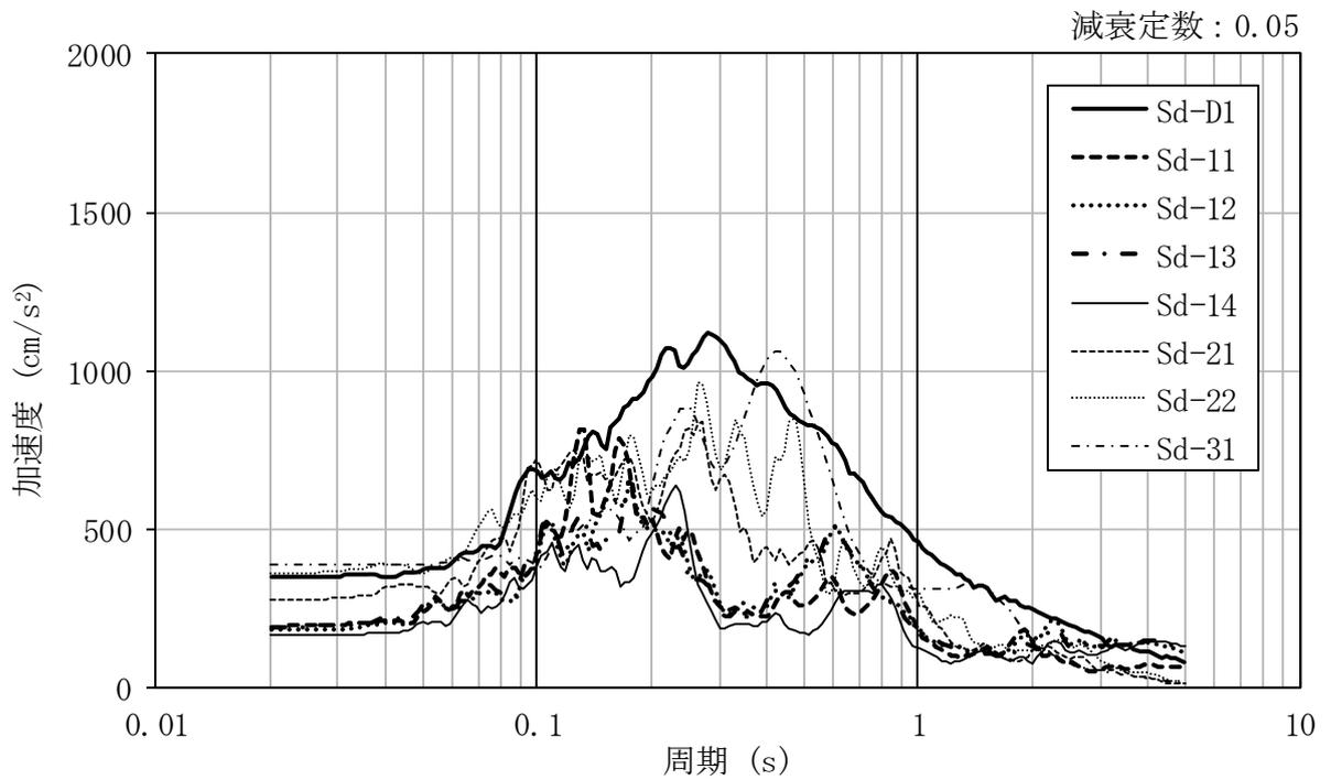
図 3-11 (2/2) 入力地震動の加速度応答スペクトル ( $S_d$ , EL. 5.8 m)
