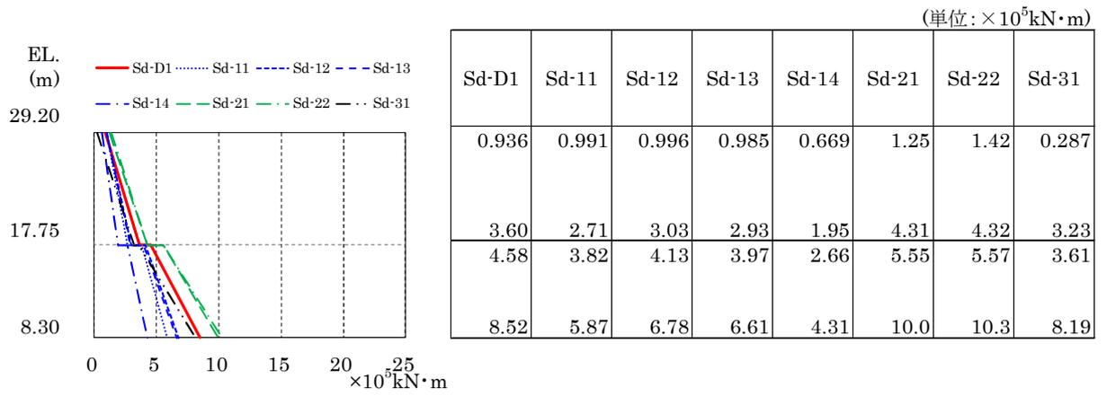
図 4-19 最大応答曲げモーメント ( $S_d$ , NS 方向)
