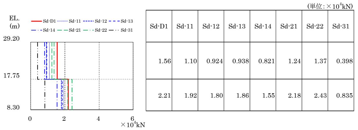
図 4-26 最大応答軸力 ( $S_d$ , UD 方向)
