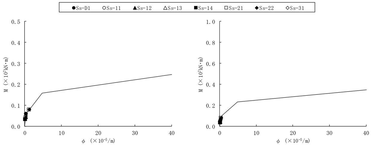
図4-14 (2/2) 曲げスケルトンカーブ上の最大応答値 ( $S_s$ , NS 方向)
