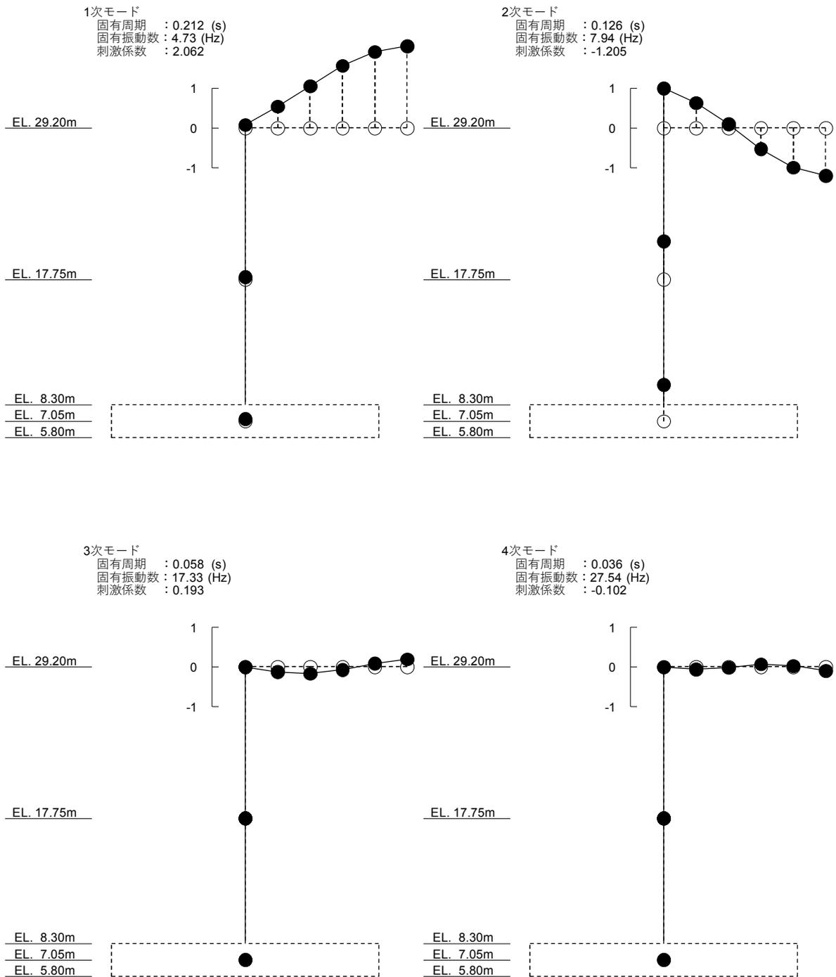
図 4-1 (3/3) 刺激関数図 (S<sub>s</sub>-D 1, UD 方向)
