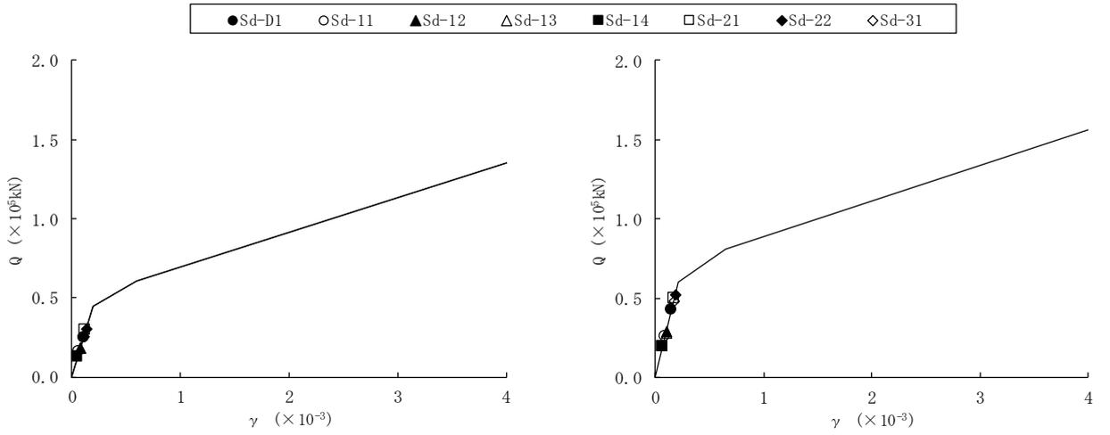
図4-27 (1/2) せん断スケルトンカーブ上の最大応答値 (S<sub>a</sub>, NS 方向)
