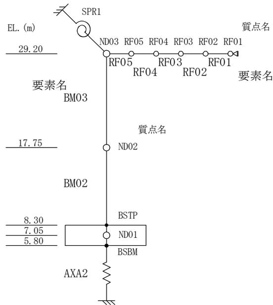
図 3-9 地震応答解析モデル (UD 方向)
