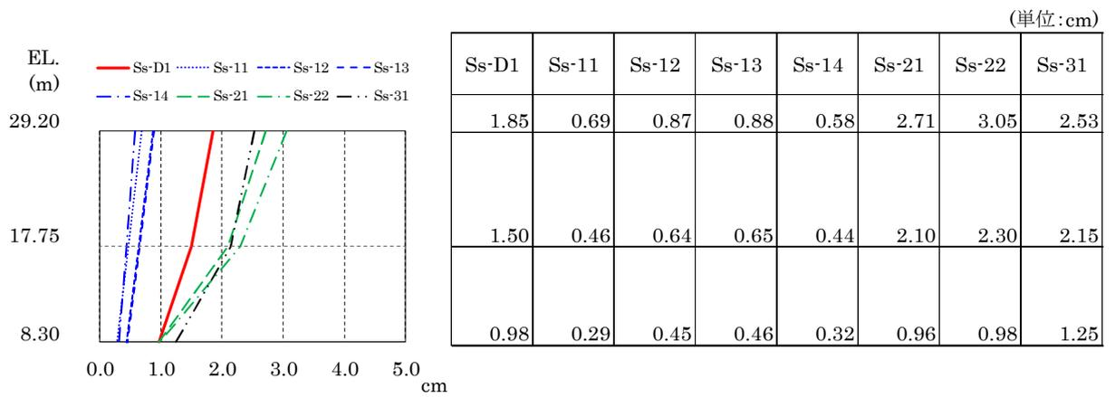
図 4-4 最大応答変位 (S<sub>s</sub>, NS 方向)
