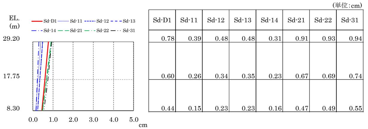
图 4-17 最大応答変位 (S<sub>d</sub>, NS 方向)
