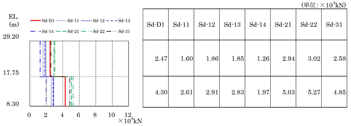
図 4-18 最大応答せん断力 ( $S_d$ , NS 方向)
