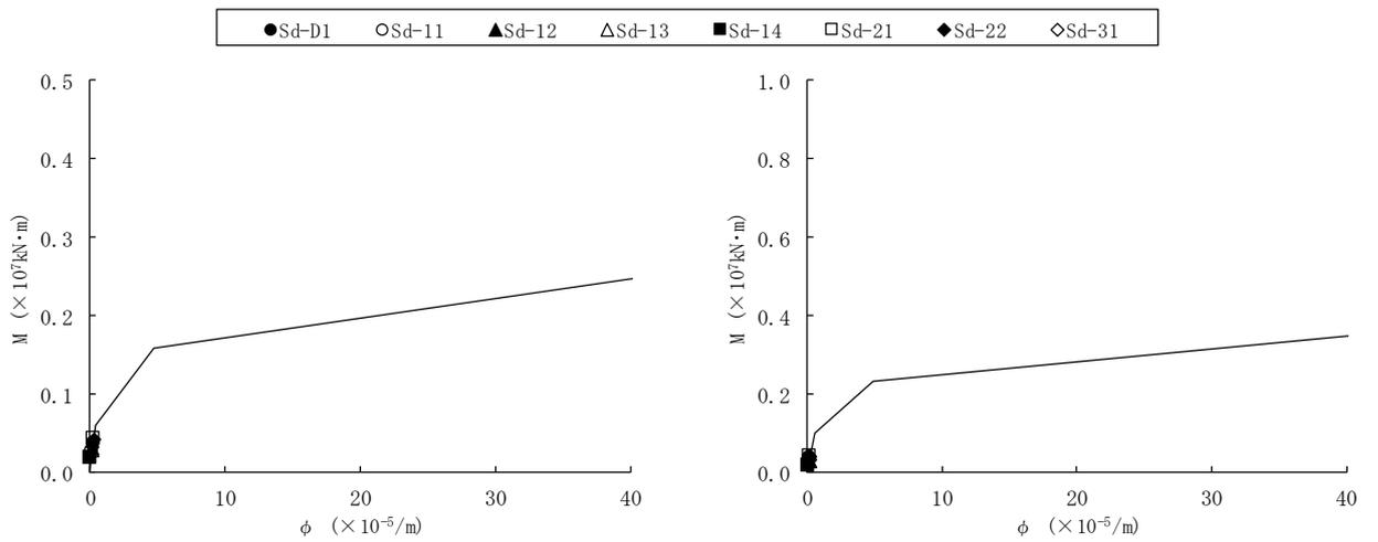
図4-27 (2/2) 曲げスケルトンカーブ上の最大応答値 (S<sub>a</sub>, NS 方向)
