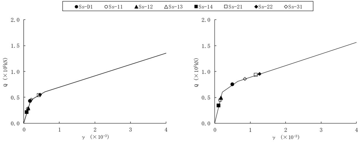
図4-14 (1/2) せん断スケルトンカーブ上の最大応答値 ( $S_s$ , NS 方向)
