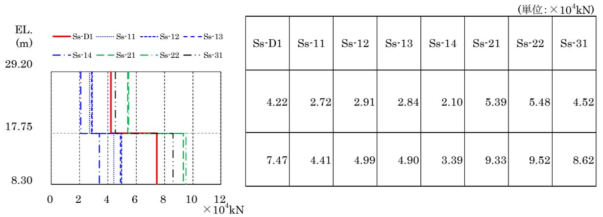
図 4-5 最大応答せん断力 ( $S_s$ , NS 方向)
