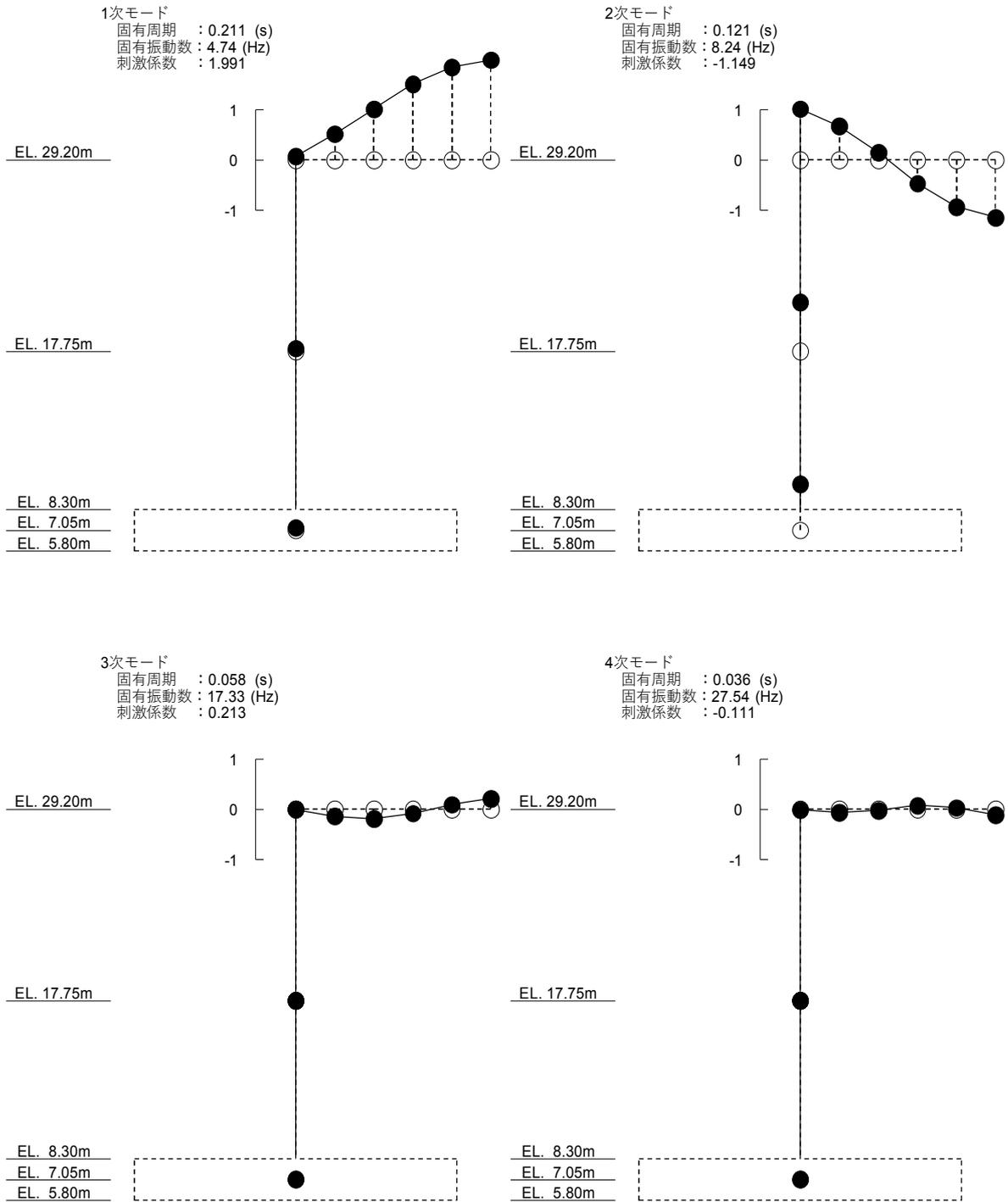
図 4-2 (3/3) 刺激関数図 (S<sub>d</sub>-D 1, UD 方向)
