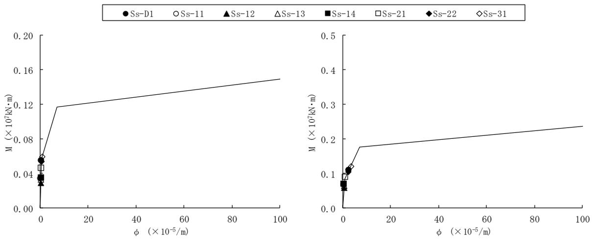
図4-15 (2/2) 曲げスケルトンカーブ上の最大応答値 (S<sub>s</sub>, EW 方向)
