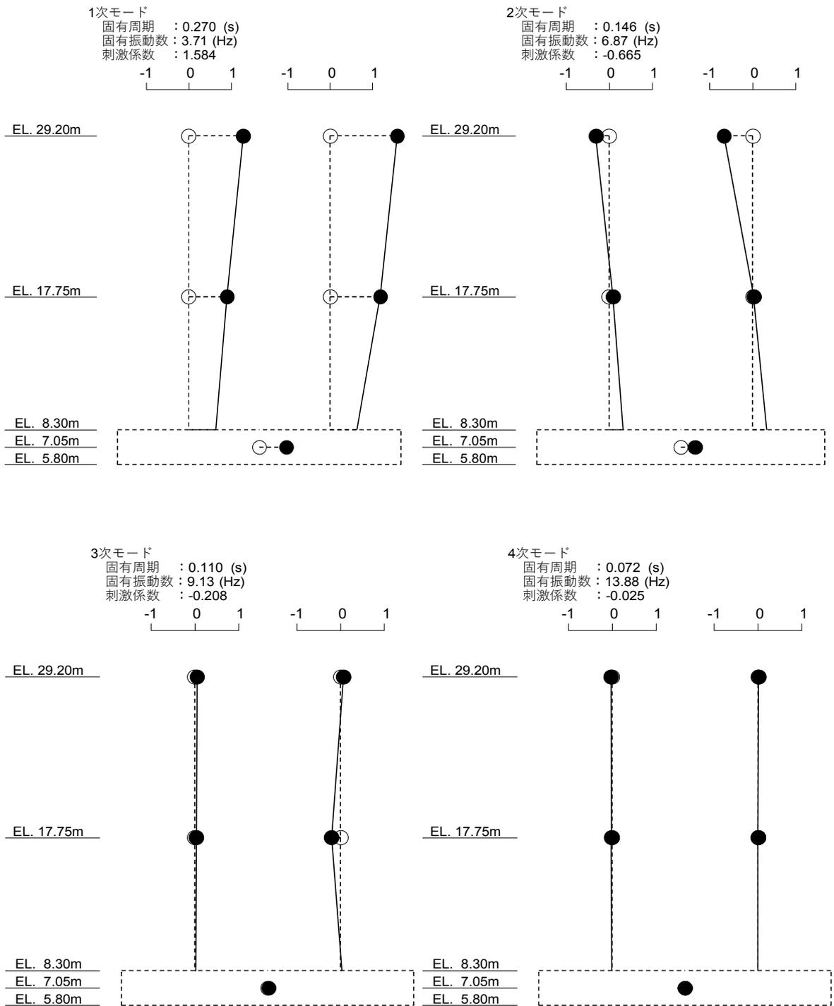
図 4-1 (2/3) 刺激関数図 (S<sub>s</sub>-D1, EW 方向)
