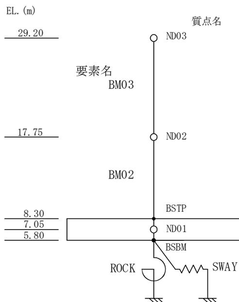
図 3-1 地震応答解析モデル (NS 方向)
