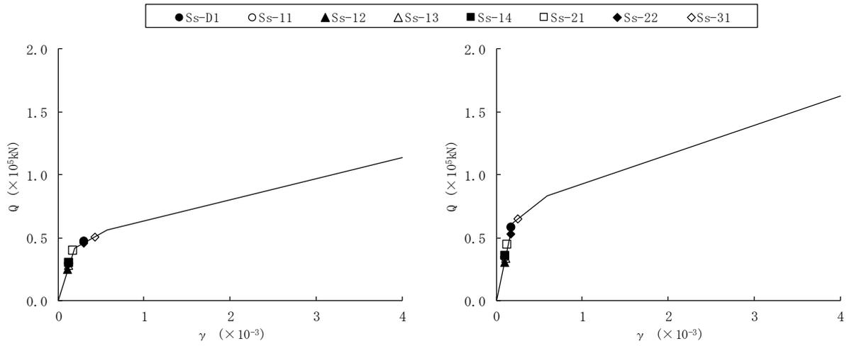
図4-15 (1/2) せん断スケルトンカーブ上の最大応答値 (S<sub>s</sub>, EW 方向)
