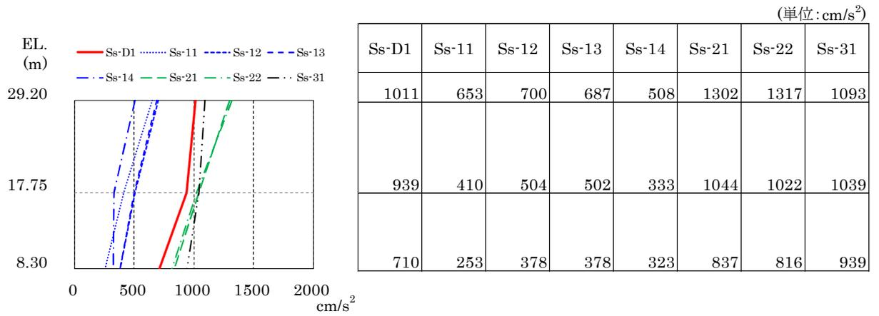
図 4-3 最大応答加速度 (S<sub>s</sub>, NS 方向)
