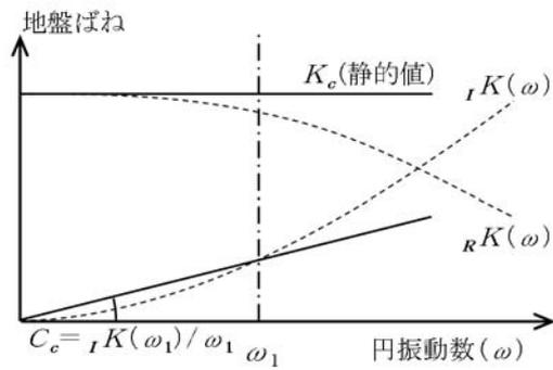
ばね定数：底面ばねは 0 Hz で定式化
