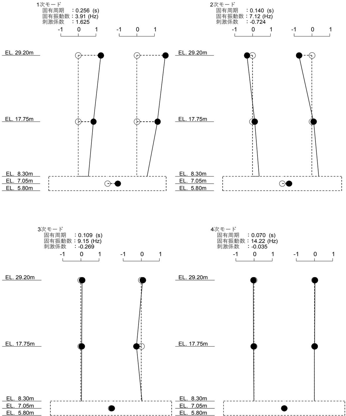
図4-2 (2/3) 刺激関数図 (S<sub>d</sub>-D1, EW方向)
