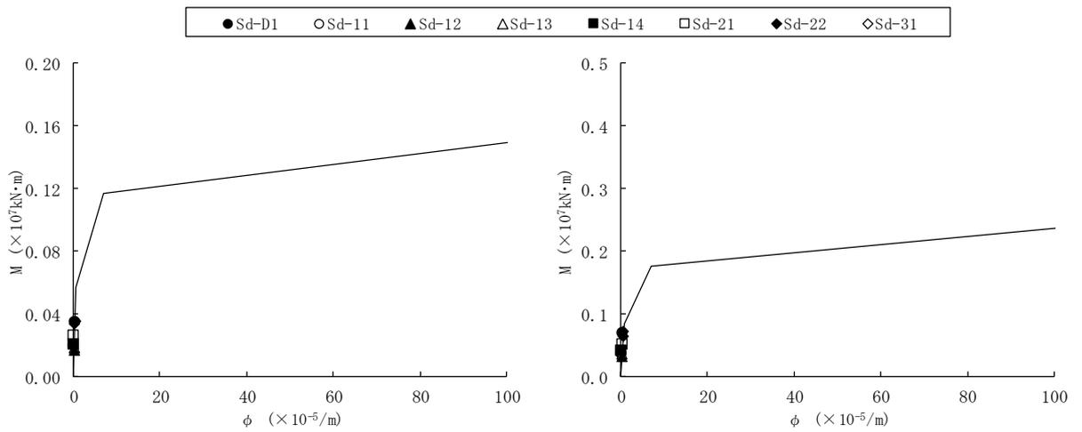
図4-28 (2/2) 曲げスケルトンカーブ上の最大応答値 ( $S_a$ , EW 方向)
