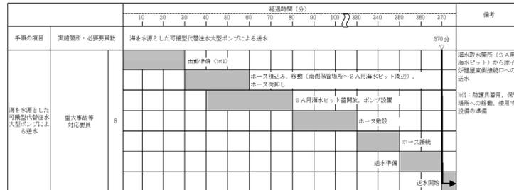
【ホース敷設にホース運搬車を使用する場合、原子炉建屋東側接続口への送水開始まで135分以内で可能である。】
