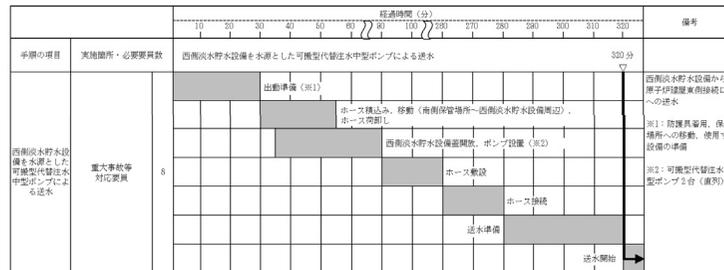
【ホース敷設にホース運搬車を使用する場合、原子炉建屋東側接続口への送水開始まで190分以内で可能である。】
