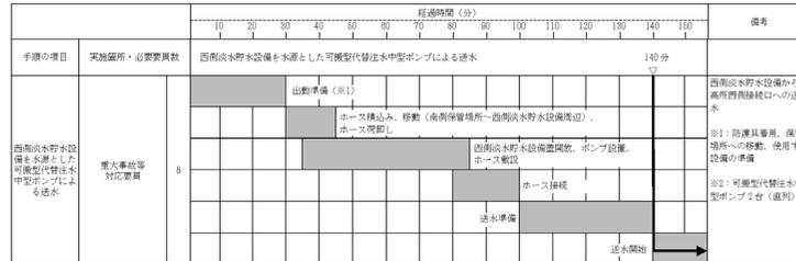
【ホース敷設にホース運搬車を使用する場合、高所西側接続口への送水開始まで140分以内で可能である。】
