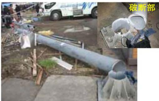
倒壊した道路標識支柱
