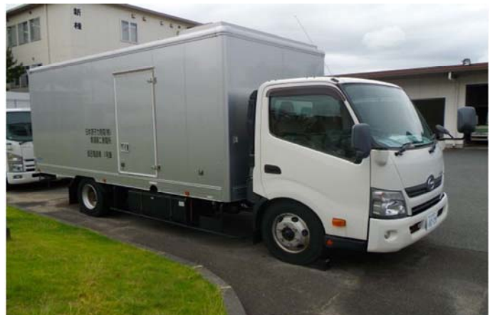
可搬型代替低圧電源車
