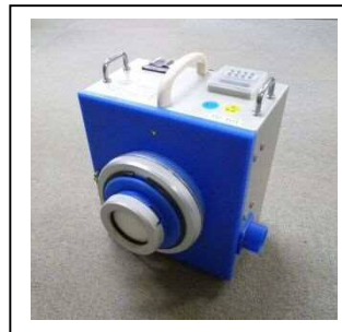
第3図 可搬型ダスト・よう素サンプラ
