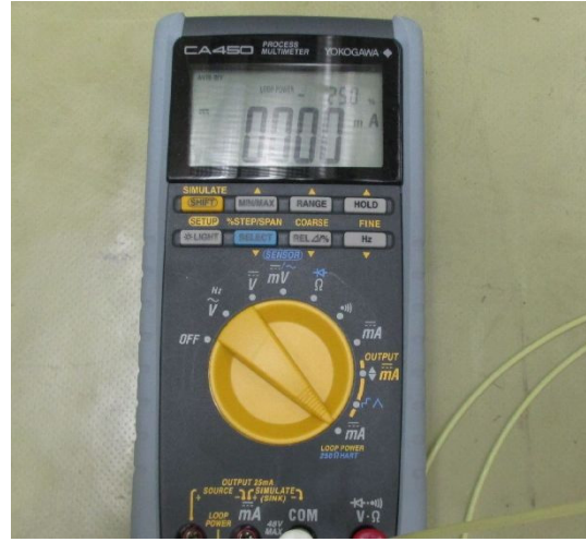
可搬型計測器 (压力・水位・流量计测用)
