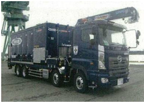
可搬型代替注水大型ポンプ
