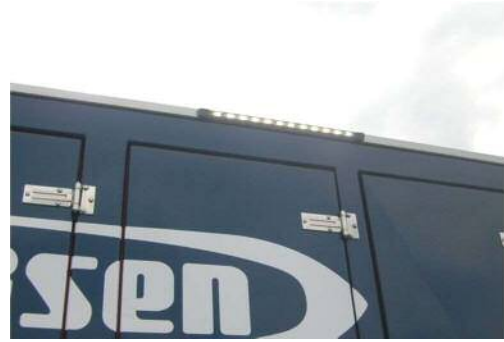
車両の作業用照明拡大
