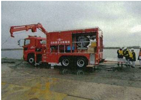
可搬型代替注水中型ポンプ
