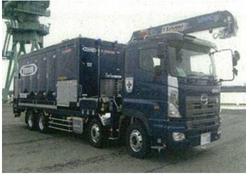
可搬型代替注水大型ポンプ
