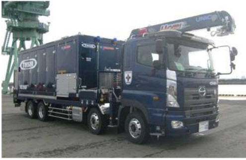
可搬型代替注水大型ポンプ
