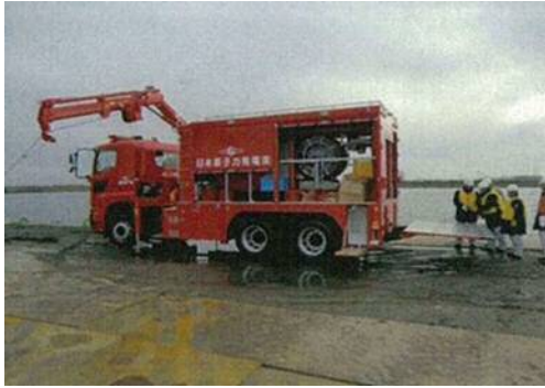
可搬型代替注水中型ポンプ
