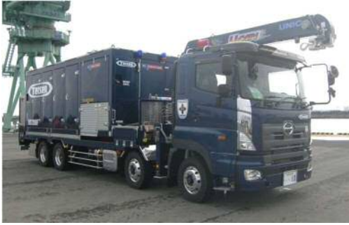
可搬型代替注水大型ポンプ（放水用）
