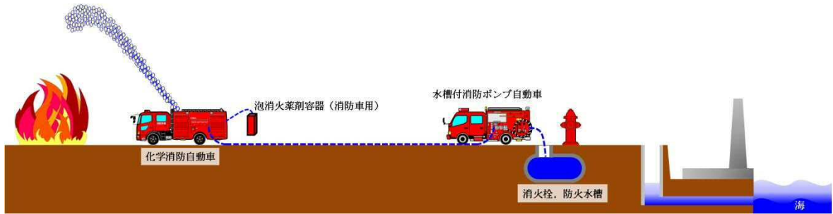
第1.12-9図 初期対応における延焼防止処置概要図
