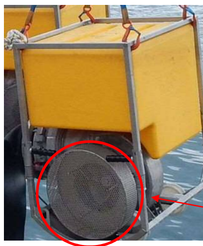
可搬型代替注水中型ポンプ又は可搬型代替注水大型ポンプ 付属の水中ポンプユニット
