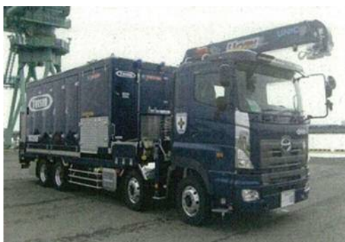
可搬型代替注水大型ポンプ
