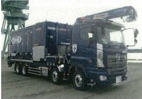
可搬型代替注水大型ポンプ
