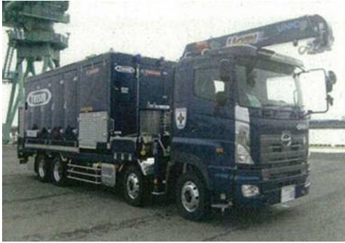
可搬型代替注水大型ポンプ
