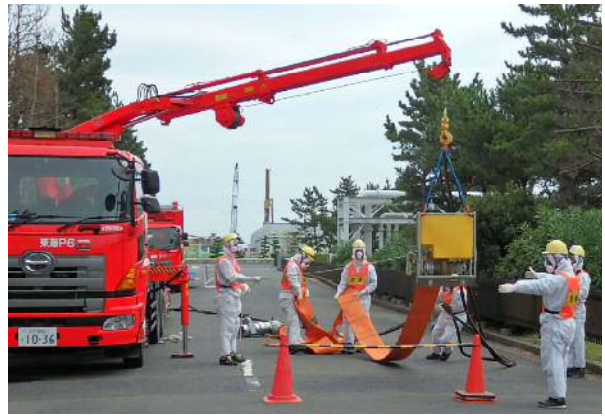
第 1.0.13-3 図 放射線防護具類を着用した状態での可搬型代替注水ポンプ車の設置作業
