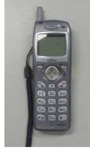
電力保安通信用 電話設備（携帯型）
