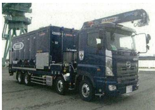
可搬型代替注水大型ポンプ
