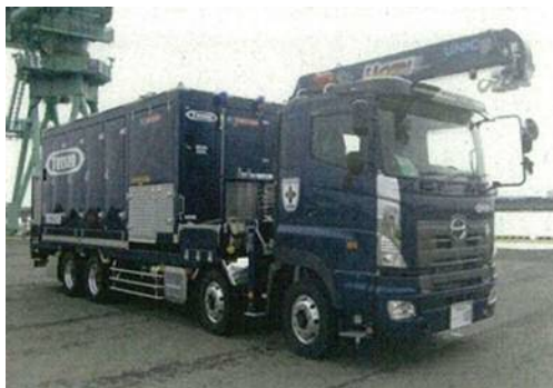
可搬型代替注水大型ポンプ
