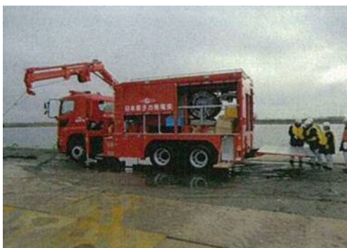
可搬型代替注水中型ポンプ
