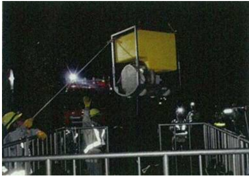
可搬型代替注水大型ポンプ
