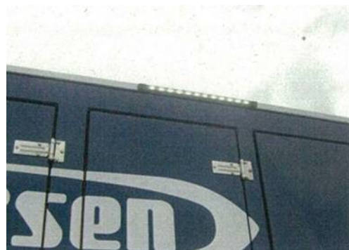
車両の作業用照明
