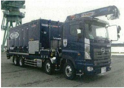
可搬型代替注水大型ポンプ
