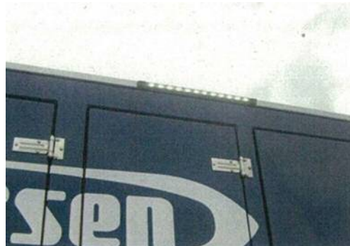
車両の作業用照明
