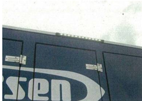
車両の作業用照明
