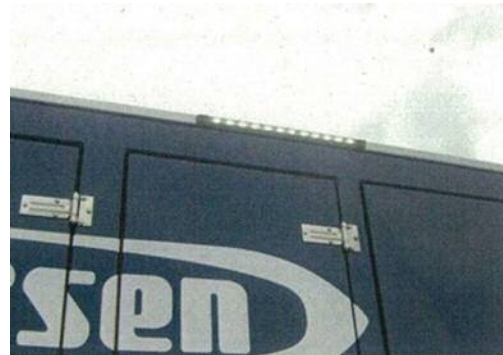
車両の作業用照明
