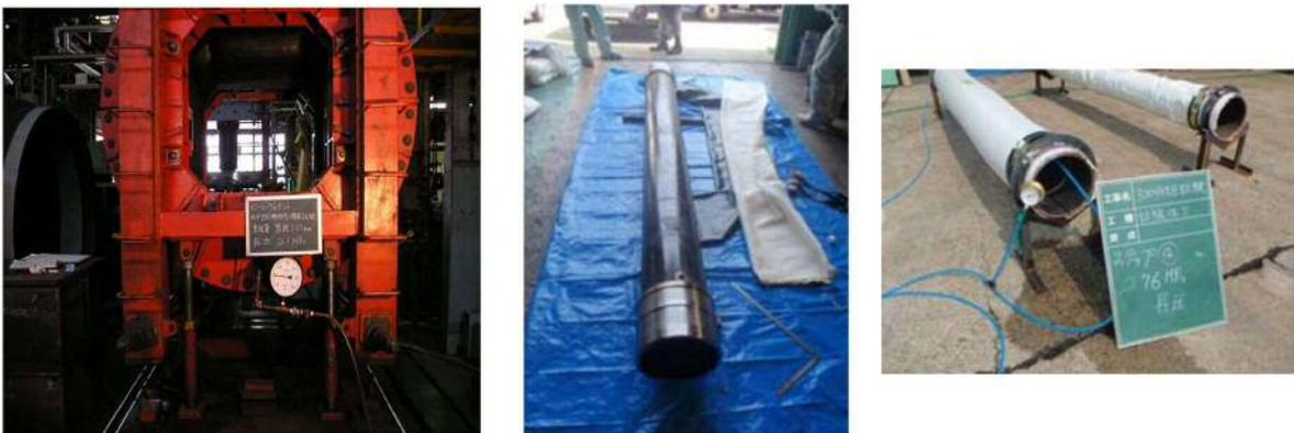
第 13 図 止水ゴム等の耐圧試験例
