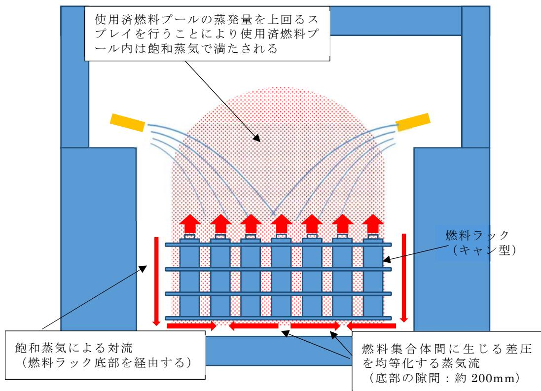
第2-1図 スプレイによる水蒸気の流れ
