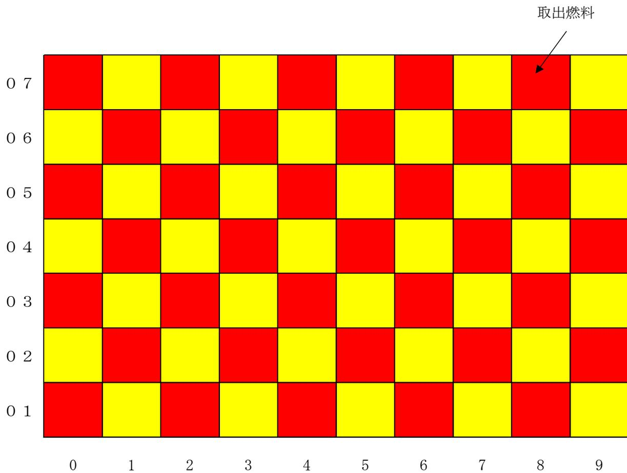
第3-2図 取出燃料を70体入りラックで分散配置した例 (1×1パターン)
