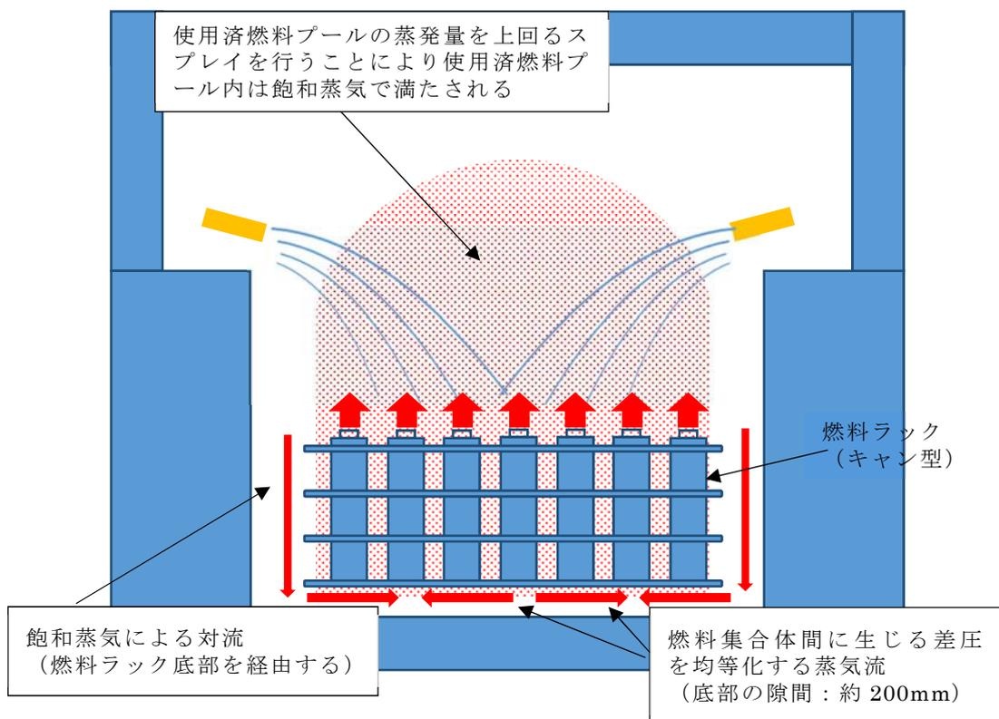
第2-1図 スプレイによる水蒸気の流れ
