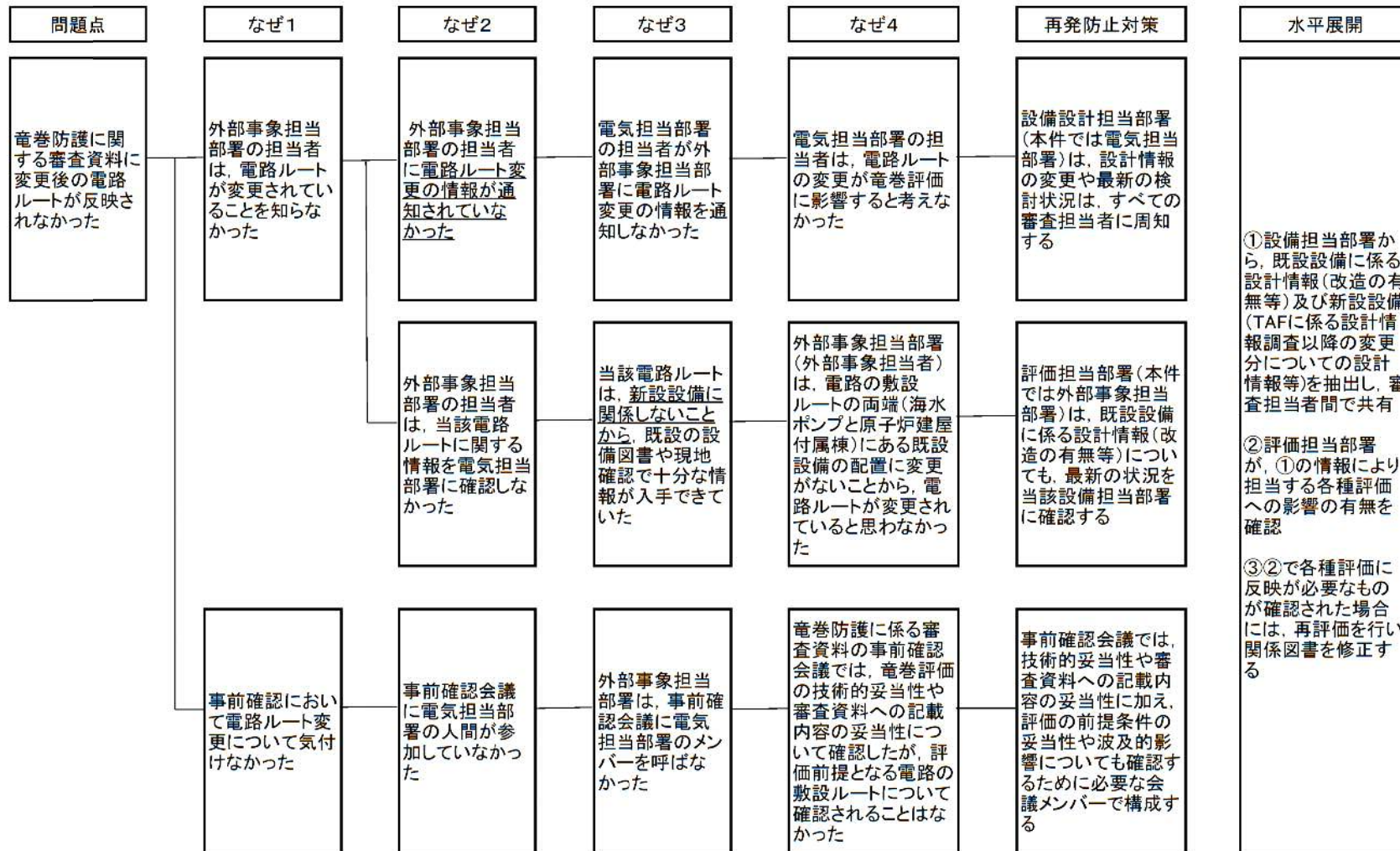
第1図 東海第二発電所 海水ポンプ用電路の変更についての原因分析
