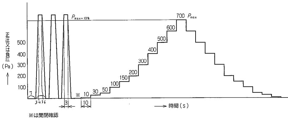
図3 加圧線図( $P_{max}$ が600 Paを超える例)
