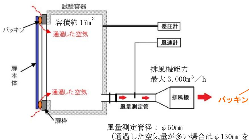
第 8 図 気密性能試験装置図
