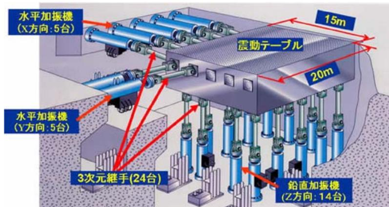
第2図 三次元振動台の概要図
