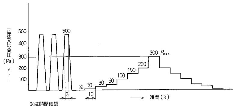
図2 加圧線図( $P_{max}$ が600 Pa以下の例)
