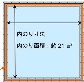
第 9 図 試験体の内り寸法図
