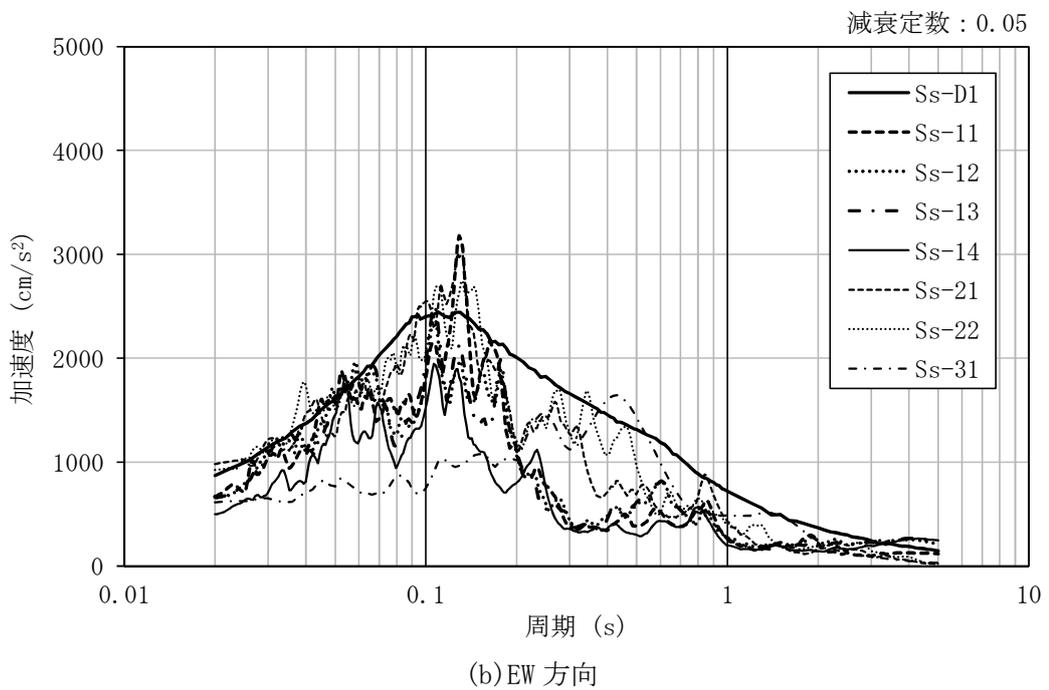
図 3-4 (1/2) 加速度応答スペクトル (S<sub>s</sub>)
