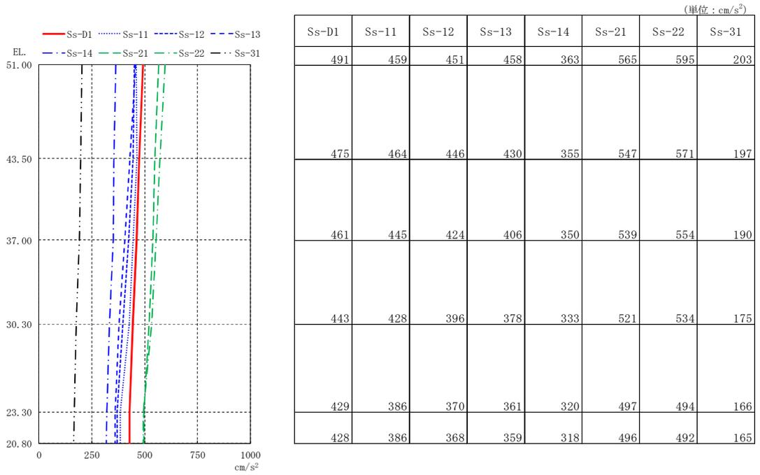
図 4-10 最大応答加速度 ( $S_s$ , UD 方向)
