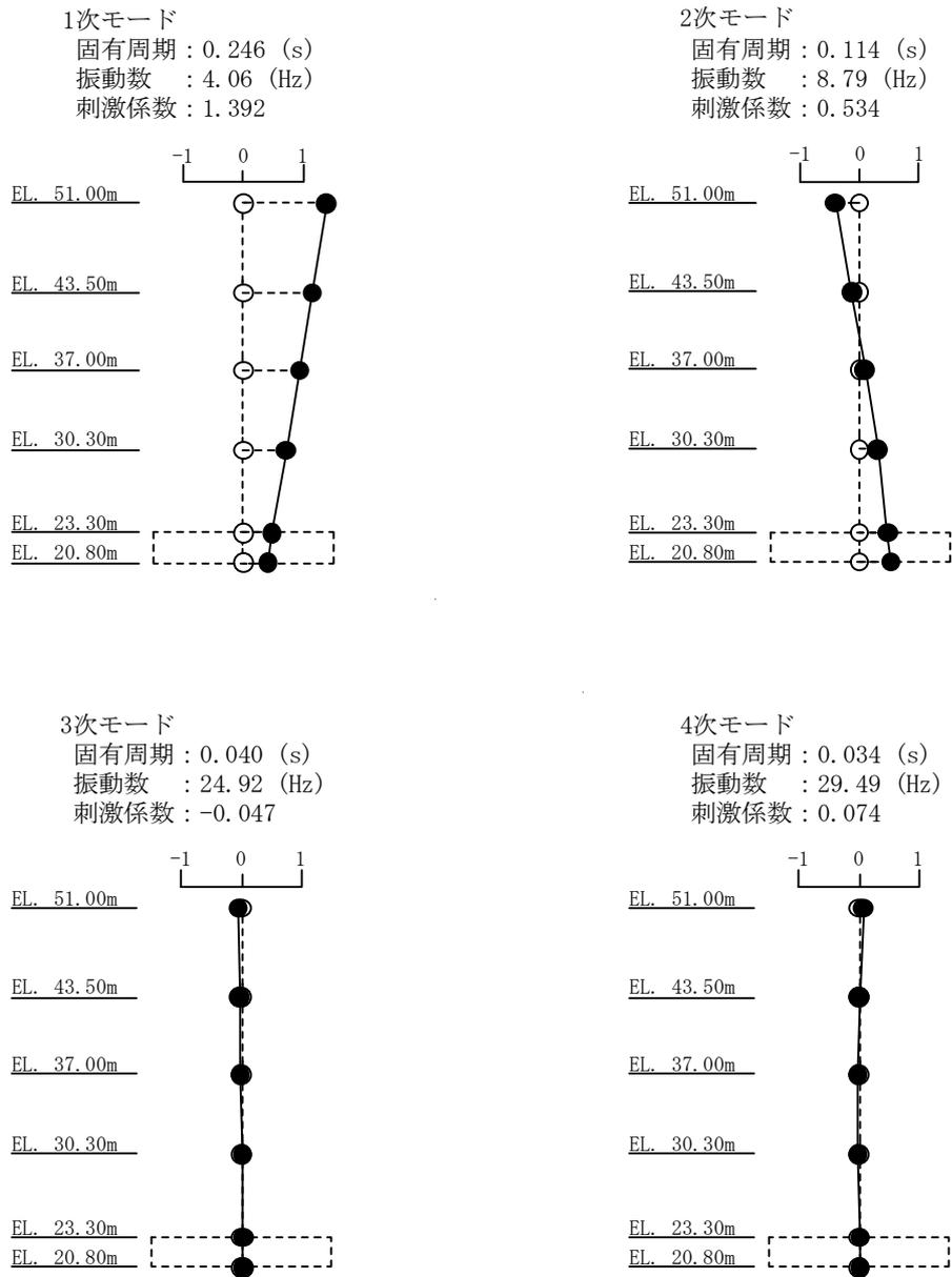
図 4-1 (1/3) 刺激関数図 (S<sub>s</sub>-D 1, NS 方向)
