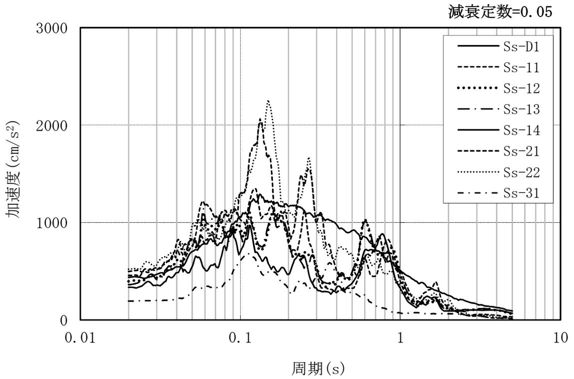
図3-16 入力地震動の加速度応答スペクトル (UD方向, S<sub>s</sub>, EL. 20.8 m)
