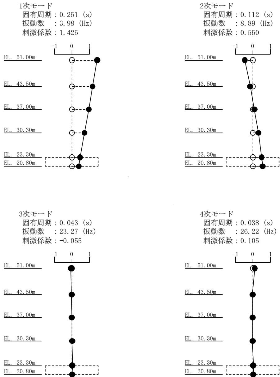
図 4-1 (2/3) 刺激関数図 (S<sub>s</sub>-D 1, EW 方向)
