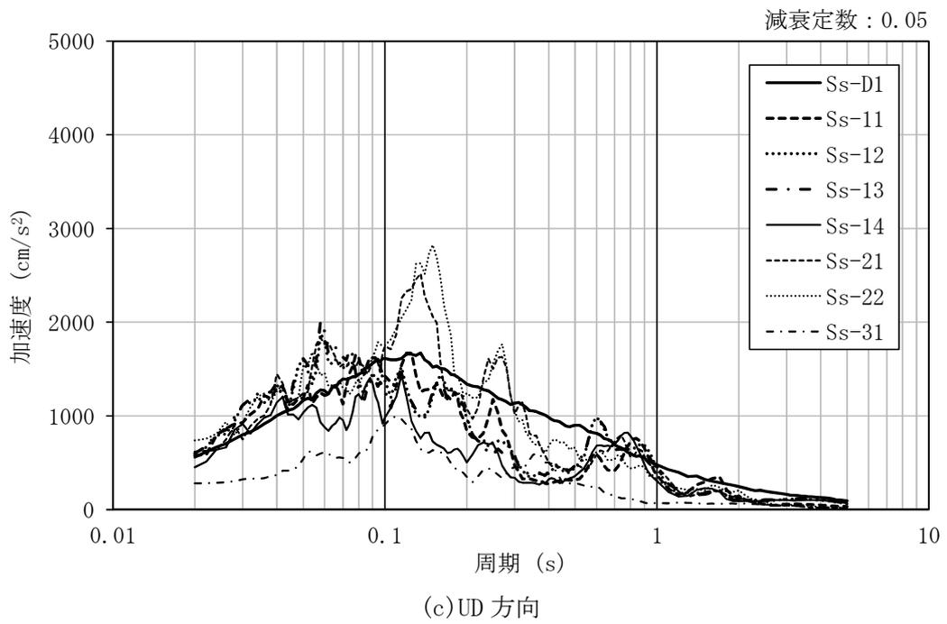
図 3-4 (2/2) 加速度応答スペクトル (S<sub>s</sub>)
