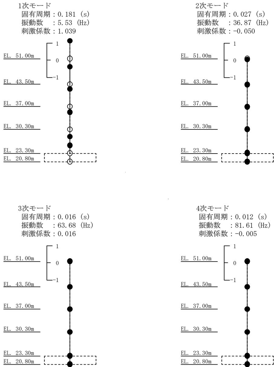
図 4-1 (3/3) 刺激関数図 (S<sub>s</sub>-D 1, UD 方向)
