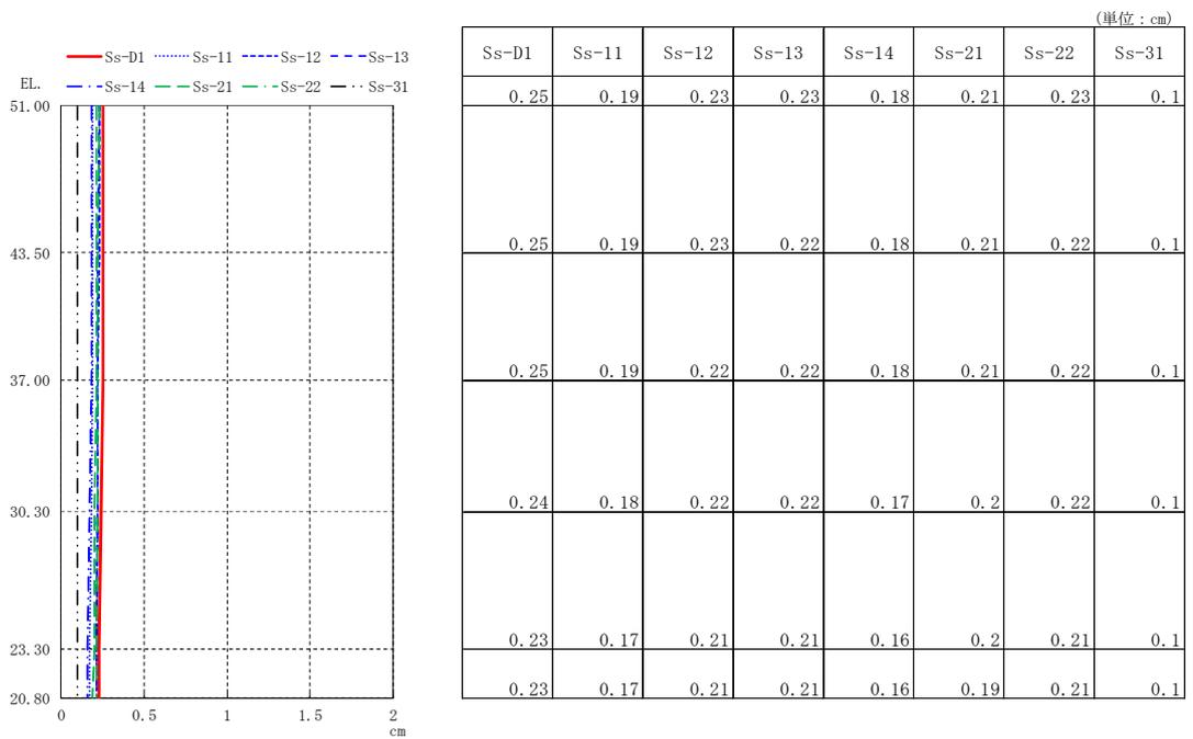
図 4-11 最大応答変位 ( $S_s$ , UD 方向)
