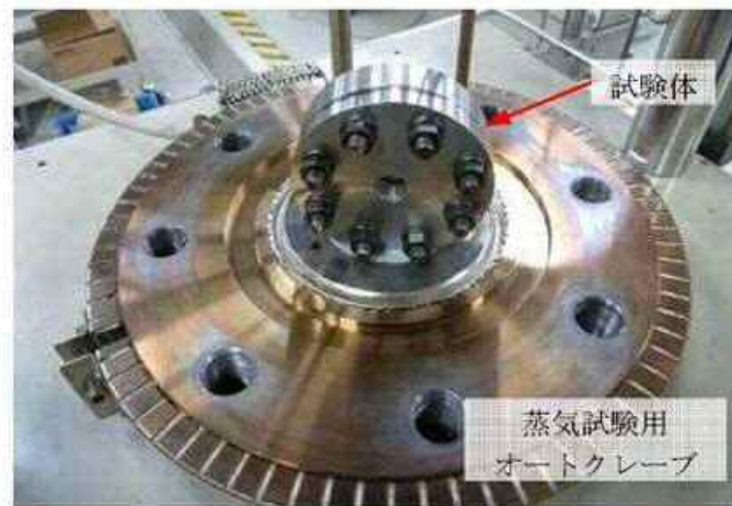
第4図 蒸気曝露試験体設置状況
