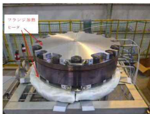
試験装置外観（フランジ密閉時）
