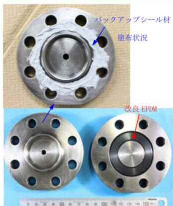
第 12 図 試験体の状況 (改良 E P D M + バックアップシール材)
