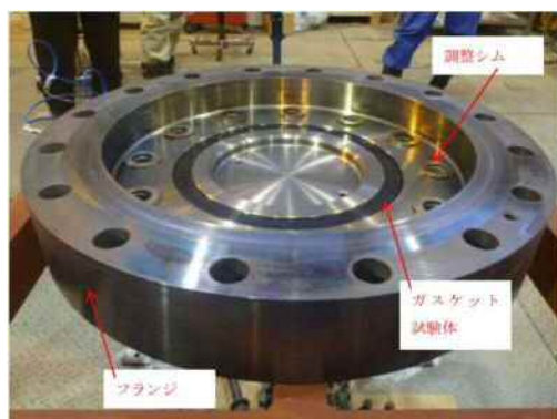
試験装置外観（フランジ開放時）
