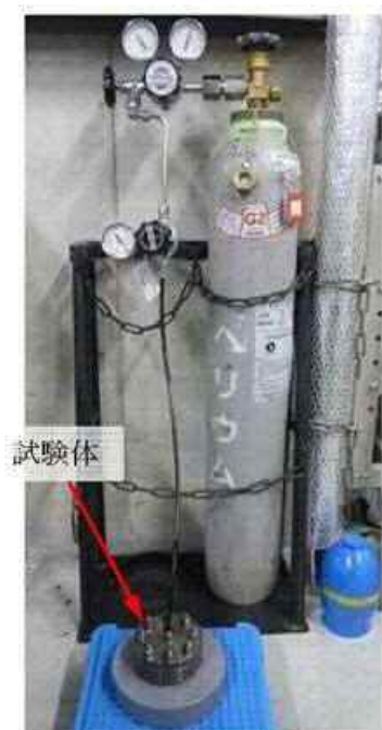
第 5 図 H e 気密確認試験状況
