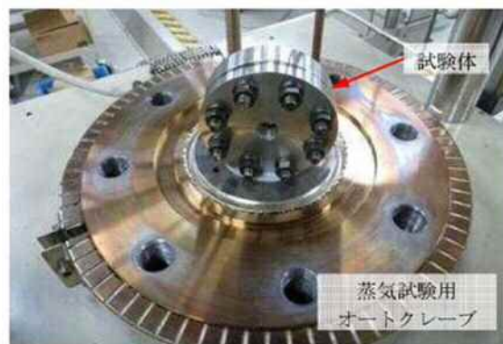
第4－5 図 改良E P D M製シール材の性能確認試験装置
