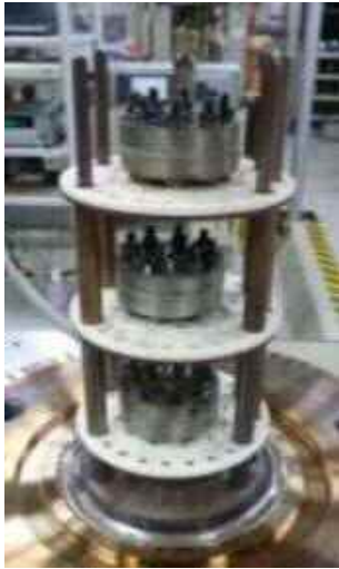
第4図 蒸気曝露 試験片設置状況
