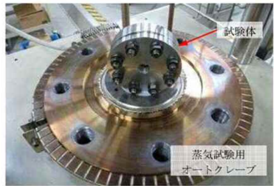
第3-5 図 改良E P D M製シール材の性能確認試験装置
