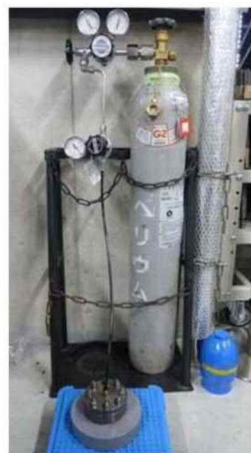
第 13 図 H e 気密確認試験状況
