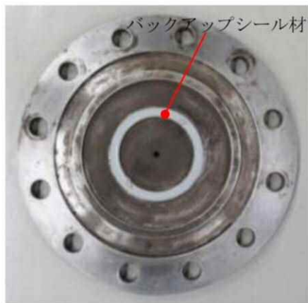
第7図 バックアップシール材塗布状況 (1.5mm 厚さ)
