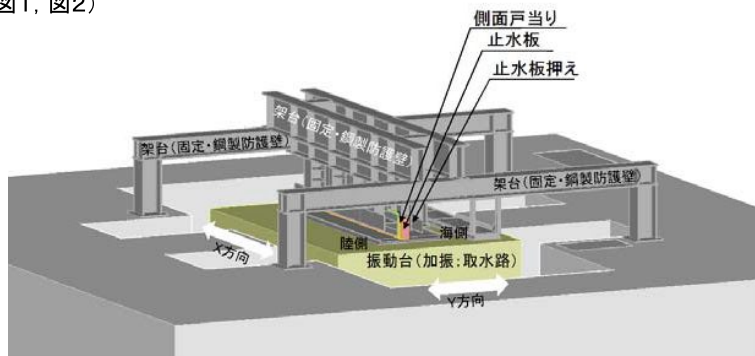
図1 加振試験装置概要図
