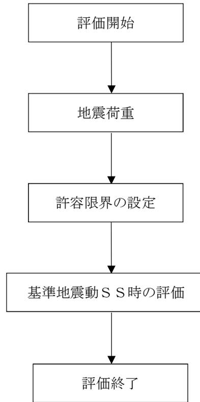
第 2-2 図 防護カバーの耐震評価フロー
