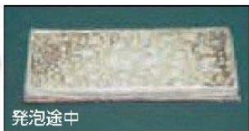
200℃～250℃程度で発泡を開始し、断熱層を形成 断熱層は、被覆を施工した鋼材表面の温度上昇を抑える
