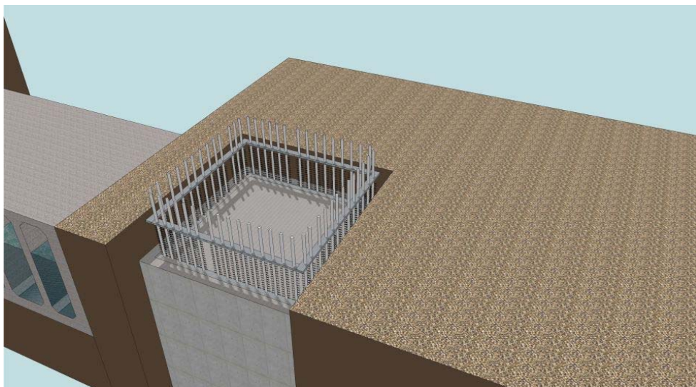
第 4-1 図 Step.1 アンカーボルトの設置
