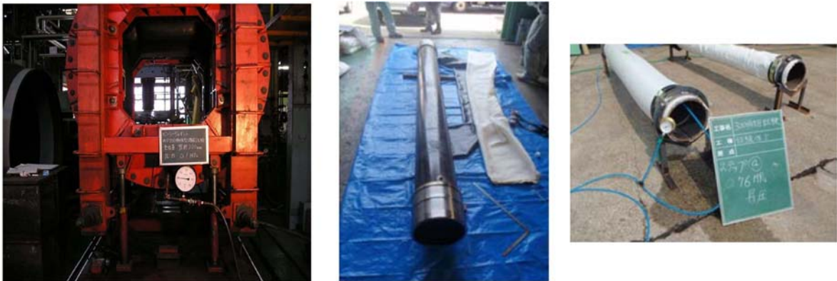
第1-26図 止水ゴム等の耐圧試験例
