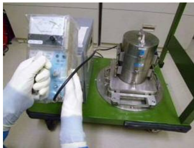
空気中の放射性物質の濃度の測定例
