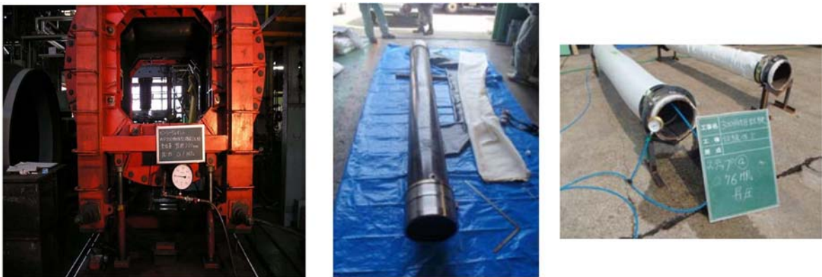
第 13 図 止水ゴム等の耐圧試験例
