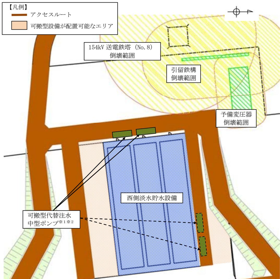
※1 淡水の注水用又は補給用として可搬型代替注水中型ポンプ 2 台の使用を想定
