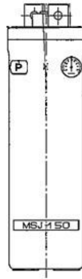
第 57-4-10 図 中性子モニタ用蓄電池 A 系・B 系外形図
