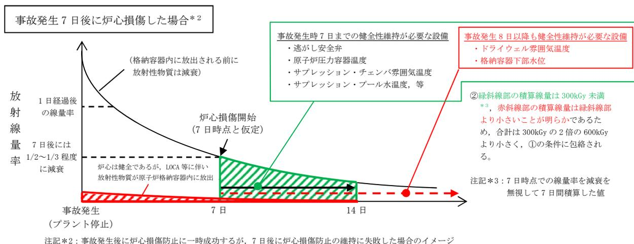
事象が緩やかに進展する場合は, プラント停止から炉心損傷までの時間が長くなり, 放射線量率は低減するため, 積算線量は, 設計条件 (640kGy) に包絡される。
