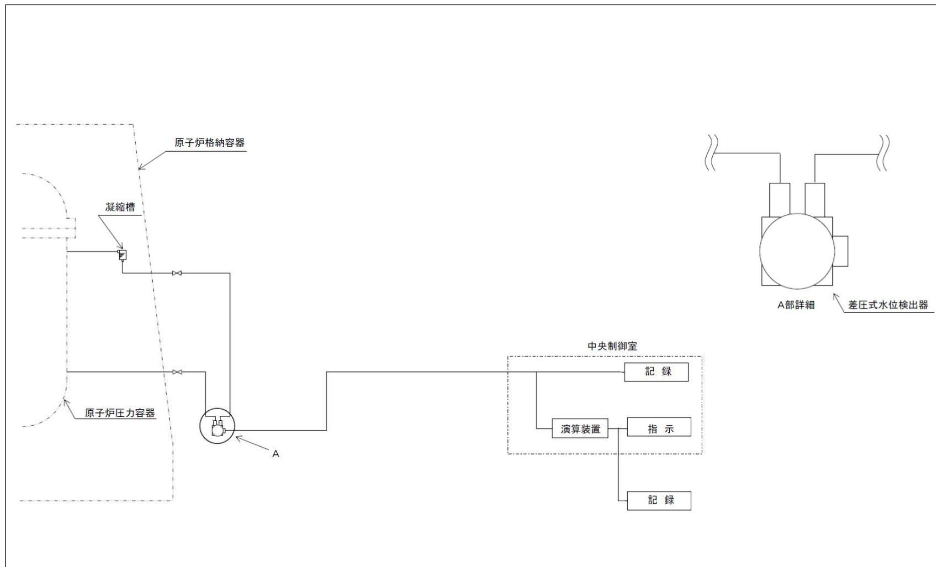
図4 検出器の構成図（原子炉水位（燃料域））
