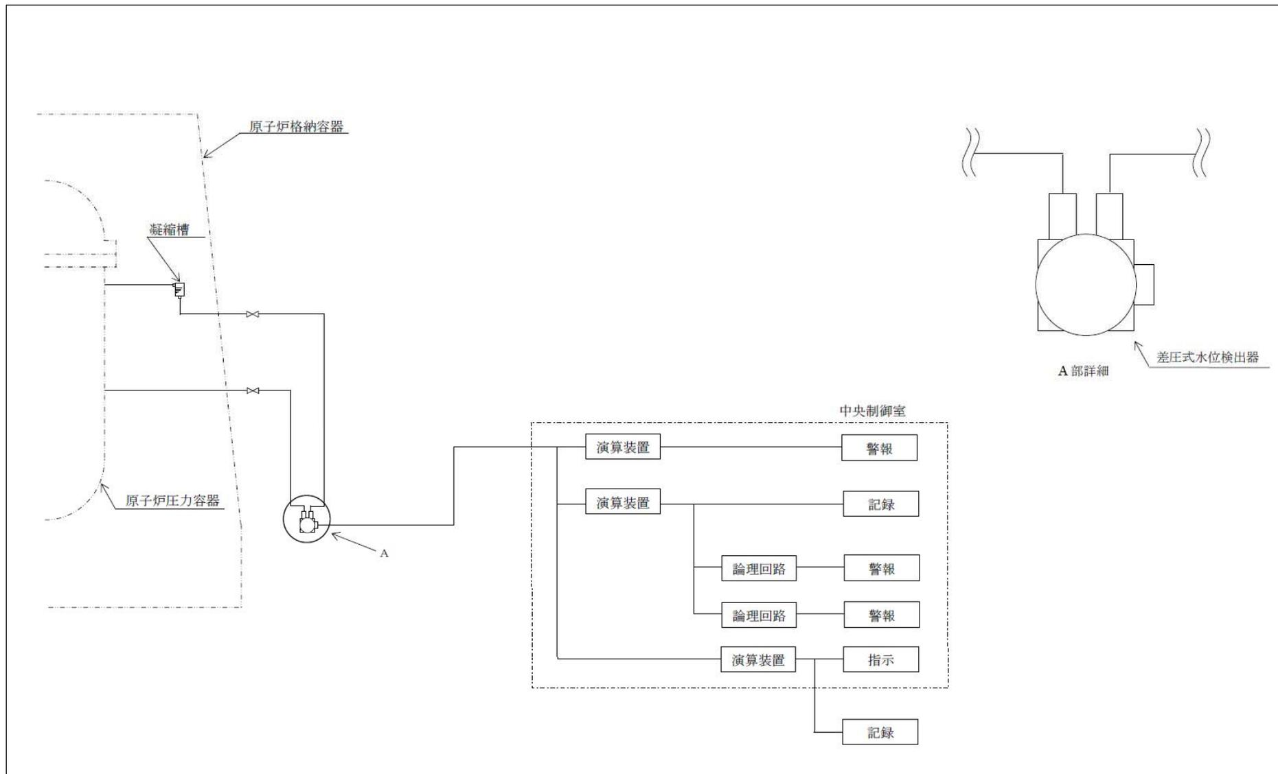
図3 検出器の構成図（原子炉水位（広帯域））
