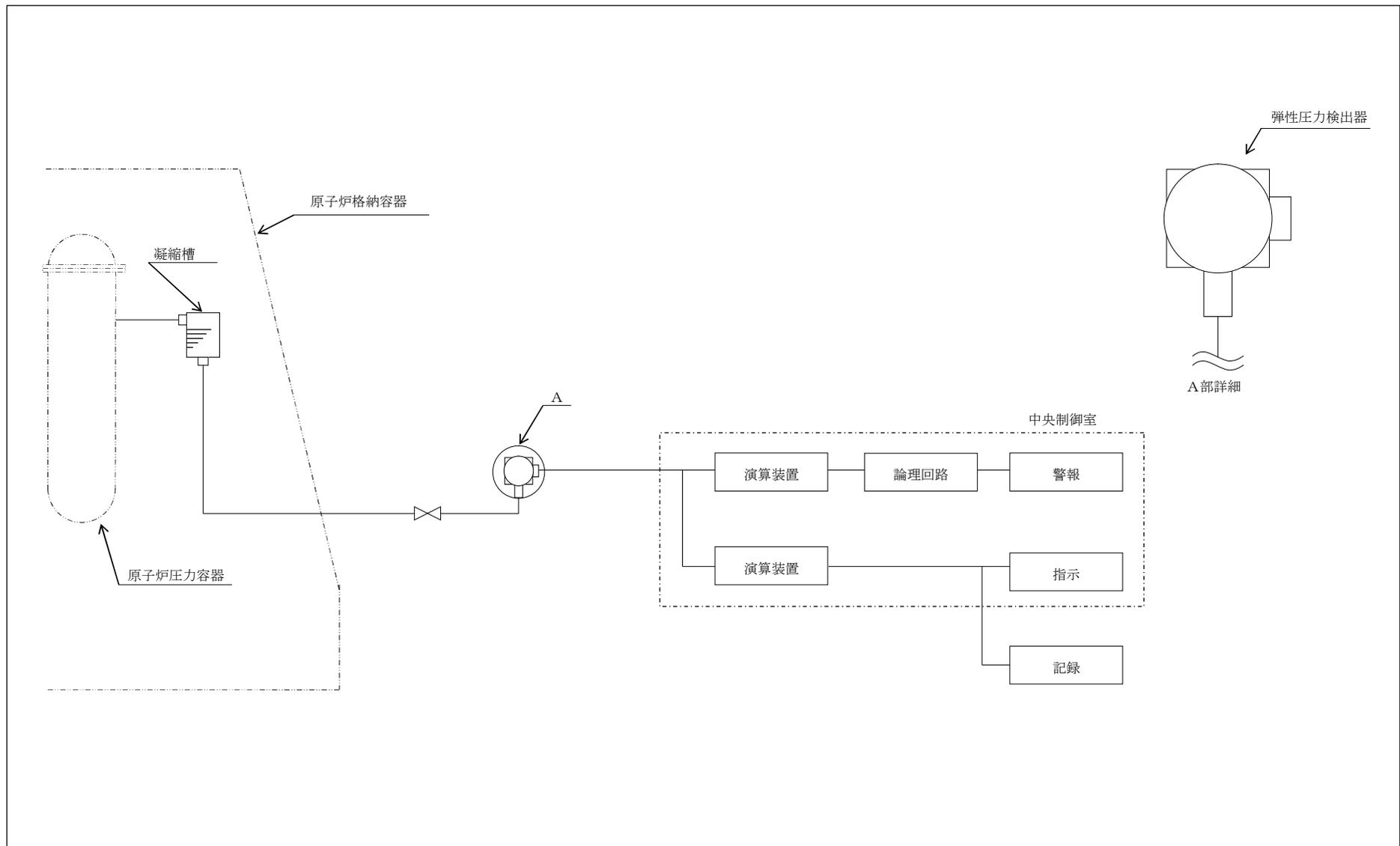
図2 検出器の構成図（原子炉圧力（SA））
