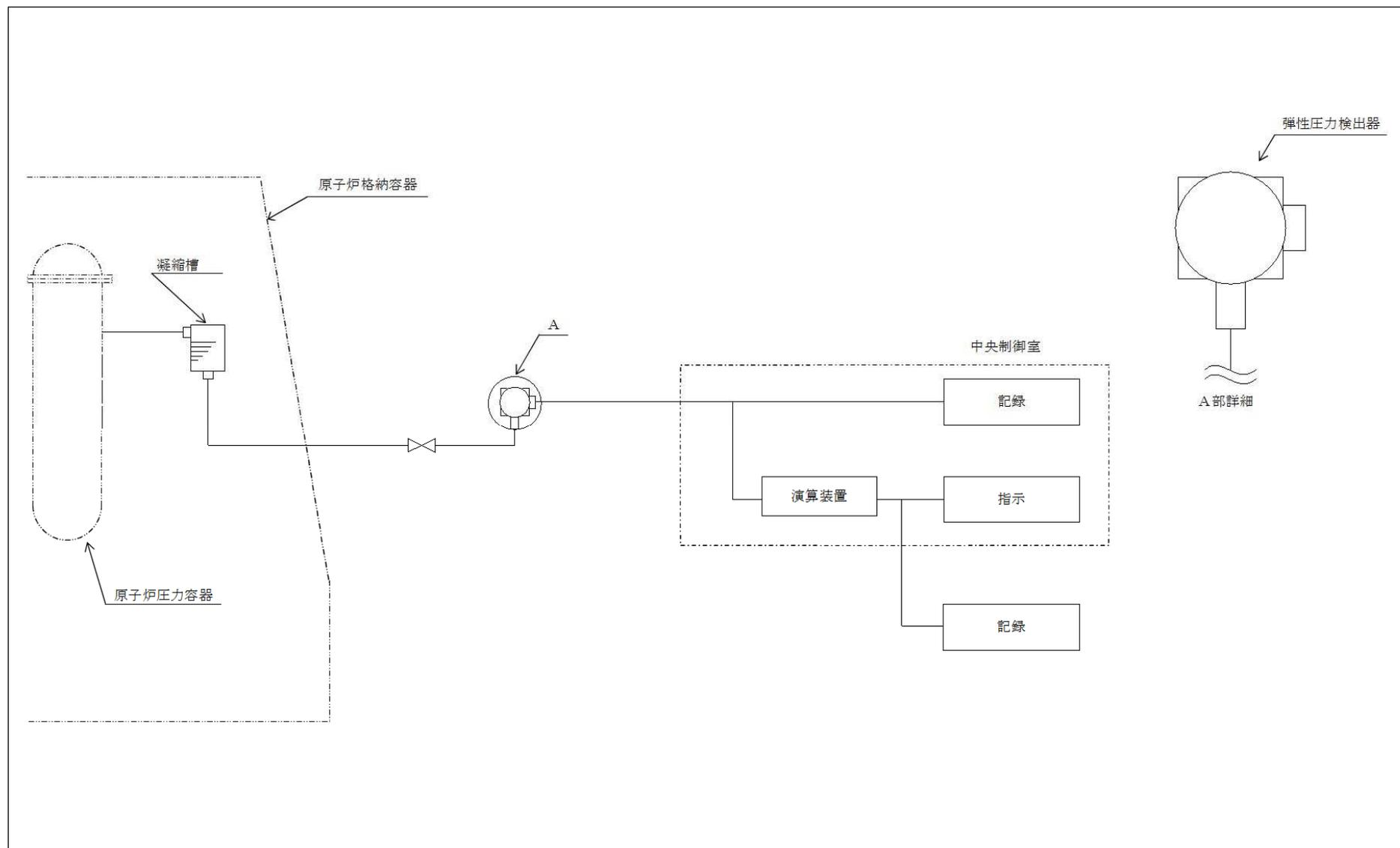
図1 検出器の構成図（原子炉圧力）
