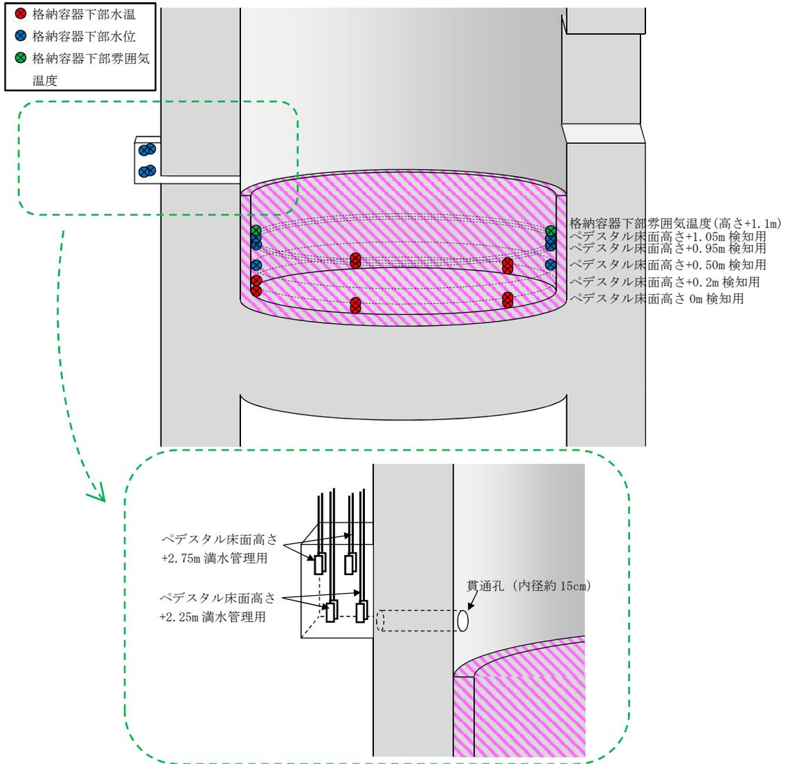
図3 格納容器下部水位の配置イメージ
