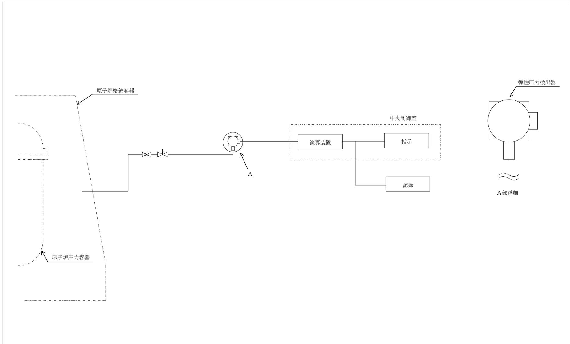
図7 検出器の構成図（ドライウェル圧力）
