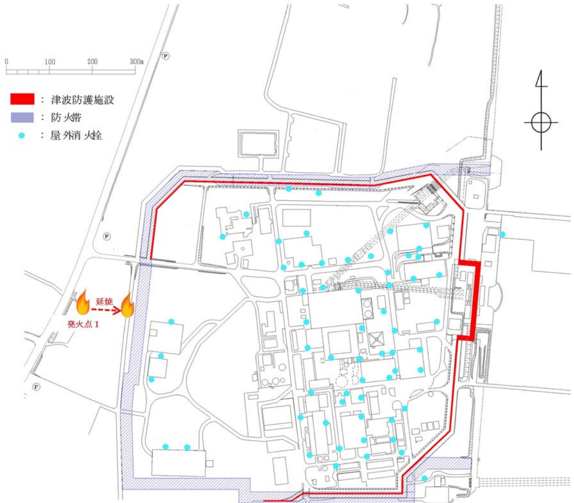
図 屋外消火栓の設置位置
