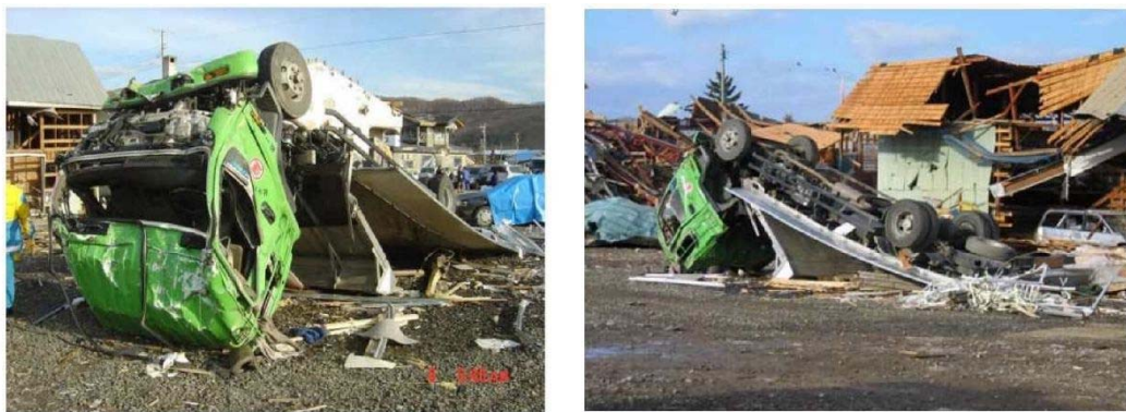
図5-5 竜巻による被災後の4tトラックの様子 (12) (14)
