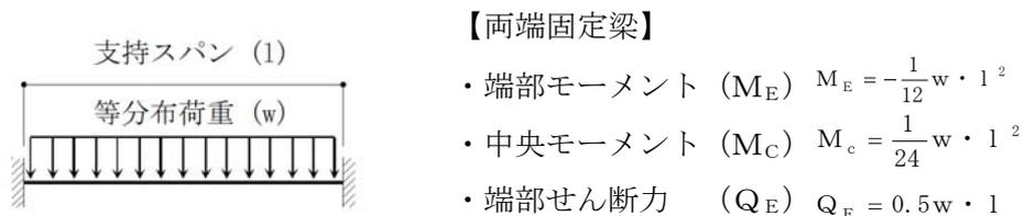
図 3-11 使用済燃料乾式貯蔵建屋 屋根スラブの解析モデル(両端固定梁)
