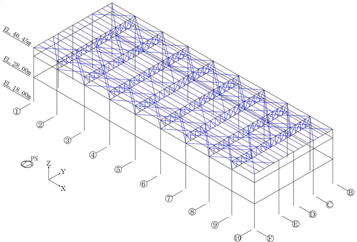
図 3-8 タービン建屋 主トラス解析モデル
