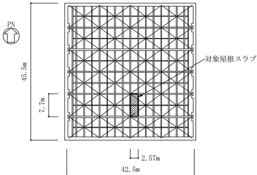
図 3-2 (1/2) 原子炉建屋原子炉棟 屋根スラブ評価部材の位置 (EL. 64.08m)
