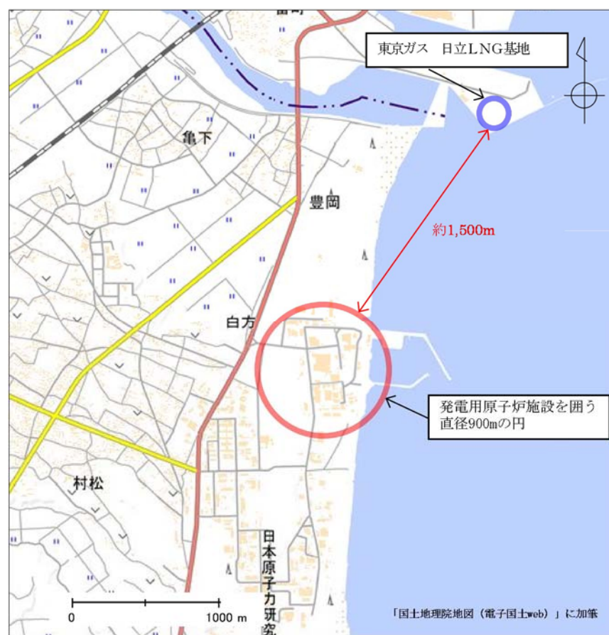
図 2.2.2-2 発電所と日立LNG基地の位置関係
