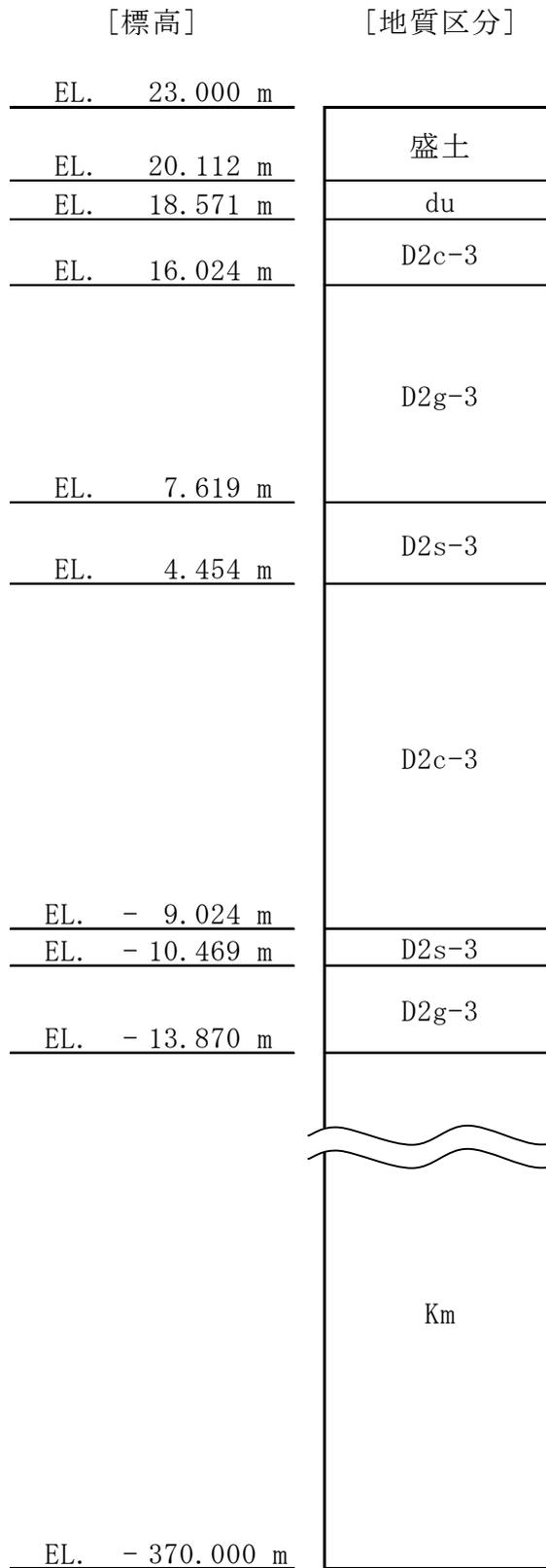
図 2-1-2 1次元応答解析用地盤モデル
