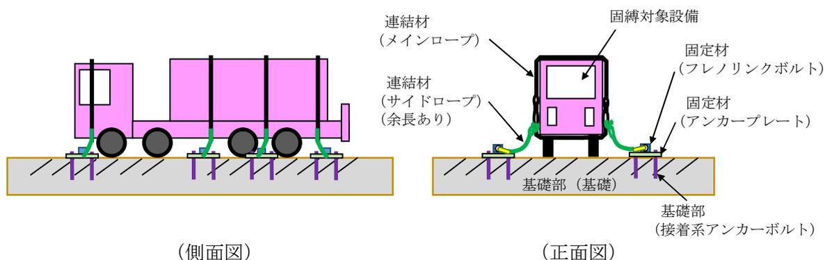
図 3-1-1 固縛装置の構造概要
