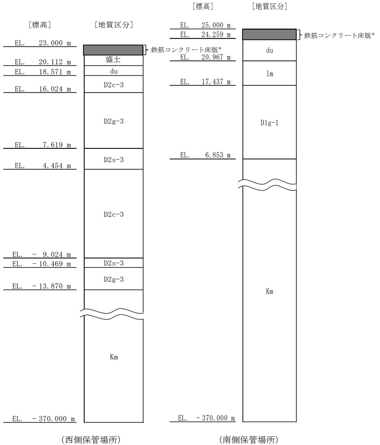
注記 \* : 鉄筋コンクリート床版の設計厚さは、各保管場所共に 1m とする。
