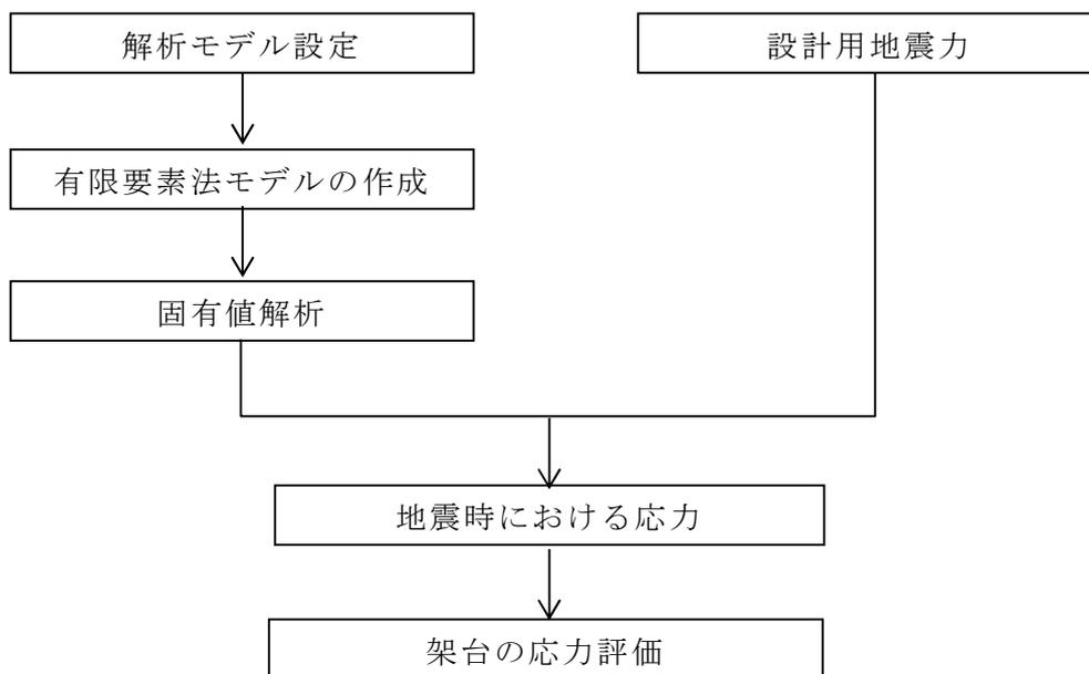
図 4-1 架台の耐震評価フロー
