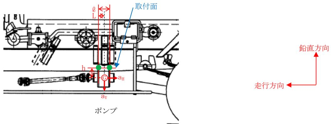
図 3-5-5 タンクローリの評価対象部位概略図 (直接支持構造物)
