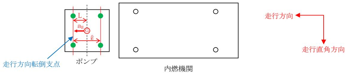
図 3-5-1 可搬型代替注水大型ポンプの評価対象部位概略図 (直接支持構造物) (1/2)
