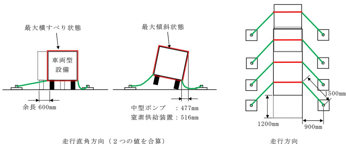
図 1 最大変位量計算の概念図
