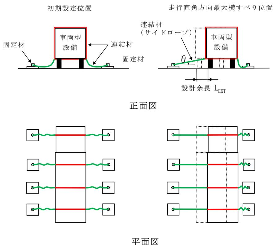
図1 固縛装置の余長の定義
