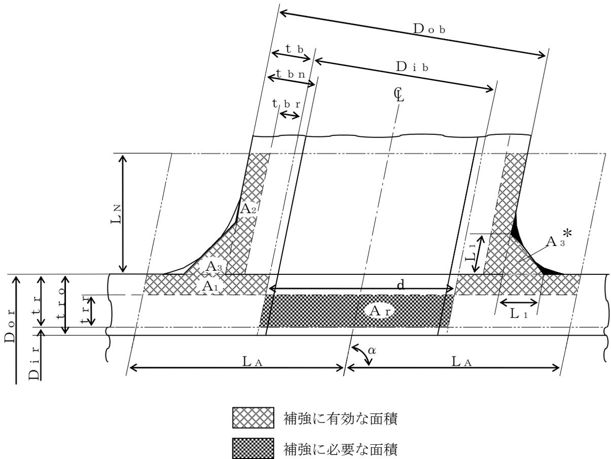
注記\*：本形式における補強に有効な面積 $A_3$ はA形及びB形と同様に $A_3=(L_1)^2 \cdot \sin \alpha \cdot S_b / S_r$ （上記 部）として算出するものとし、同補強部外側の余肉部（上記 部）は、補強面積評価上は考慮しない。
