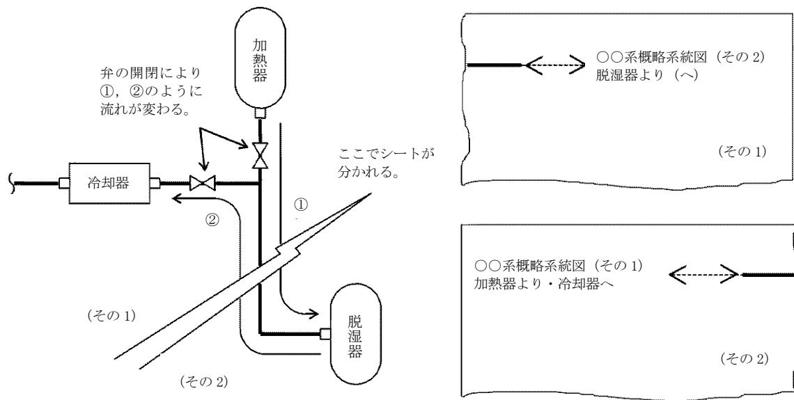
f. 接続先の配管が工認対象外である場合は、表記する必要はない。ただし、工事計画書に記載する管継ぎ手にかかる場合及び系統の接続を示すために必要なラインは、11 ページ「(9) 分岐部の申請範囲の表記」に示す表記をする。
