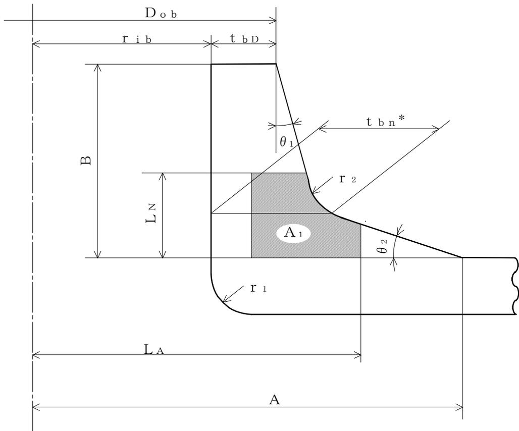
注記\* :  $t_{bn}$ は補強面積 $A_1$ の重心点を通る管台肉厚
