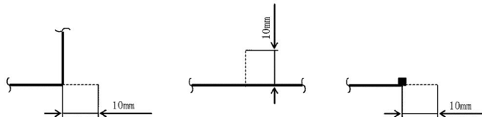
注2：クラス1管及びクラス2管以外であっても、工認系統図上の分岐、合流を明確にする必要がある場合にはクラス1管及びクラス2管の表記とする。
