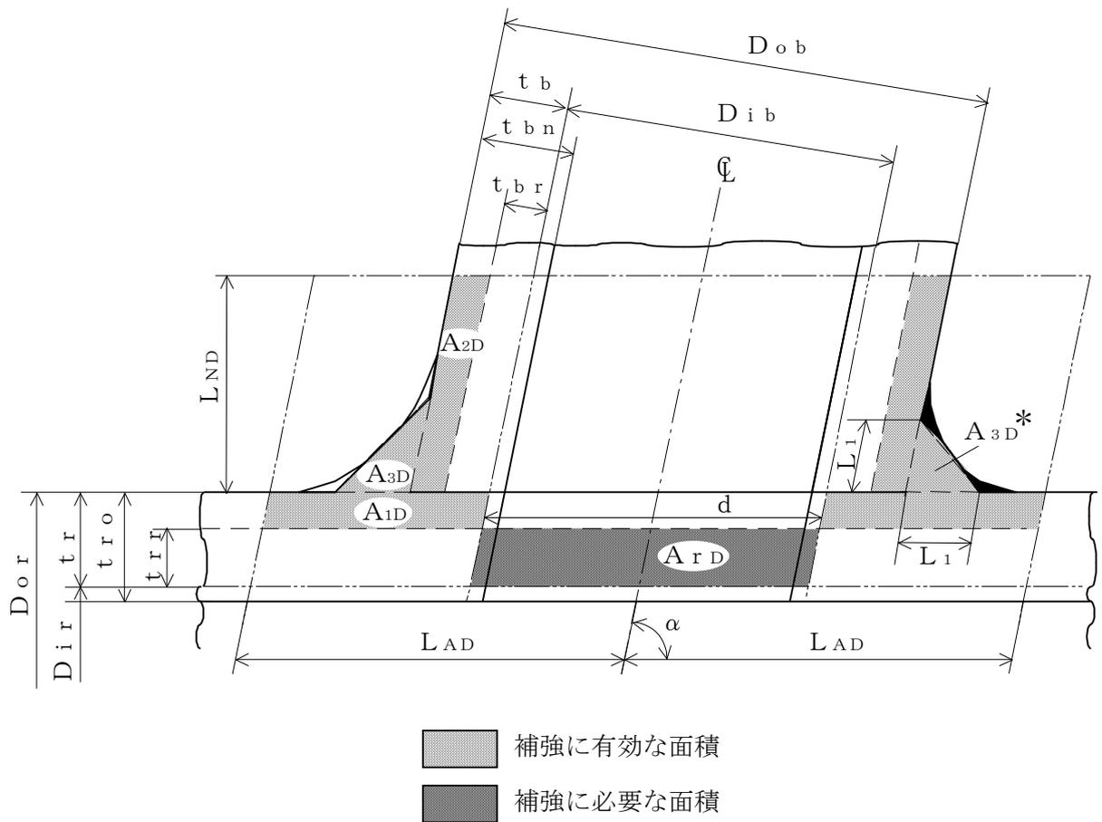
注記\*：本形式における補強に有効な面積 $A_{3D}$ はA形及びB形と同様に $A_{3D} = (L_1)^2 \cdot \sin \alpha \cdot S_b / S_r$ （上記  部）として算出するものとし、同補強部外側の余肉部（上記  部）は、補強面積評価上は考慮しない。
