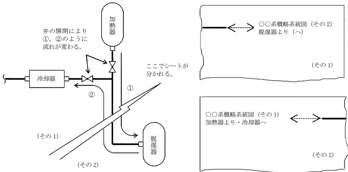
f. 接続先の配管が工認対象外である場合は、表記する必要はない。ただし、工事計画書に記載する管継ぎ手にかかわる場合及び系統の接続を示すために必要なラインは、11ページ「(9) 分岐部の申請範囲の表記」に示す表記をする。
