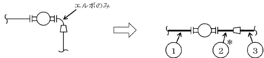
c. 設計・建設規格規定の J I S 既設品以外の管継手を使用する場合
