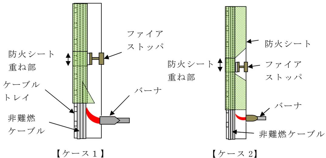
第 4-1 図 内部発火を模擬した供試体 (例)
