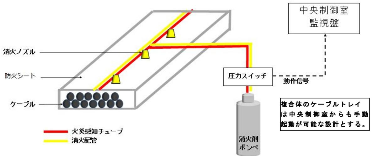
ケーブルトレイ消火設備の自動起動の動作原理
