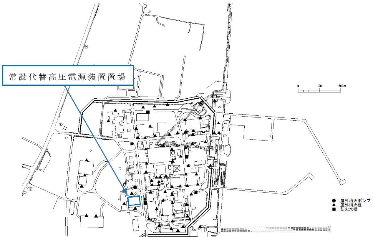
第 1 図 屋外消火栓配置図
