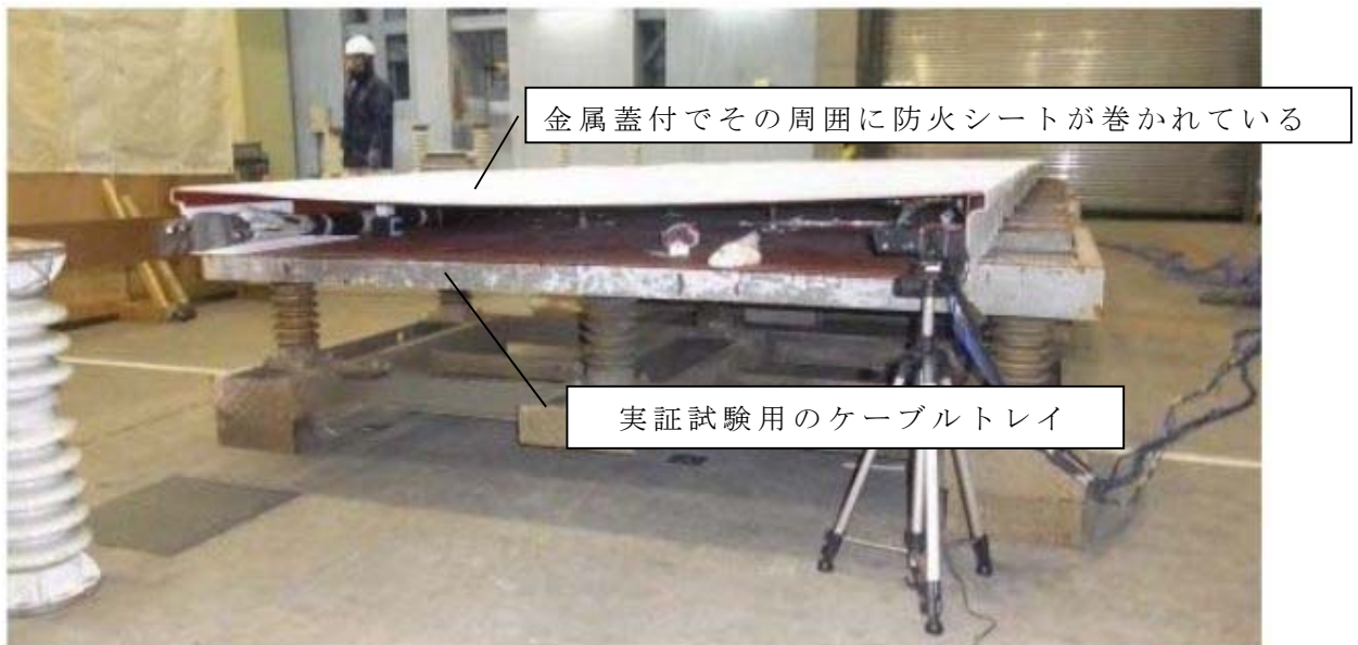
第 3 図 実証試験用のケーブルトレイ
