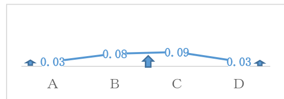
止水板の浮き上がり量 (mm)
