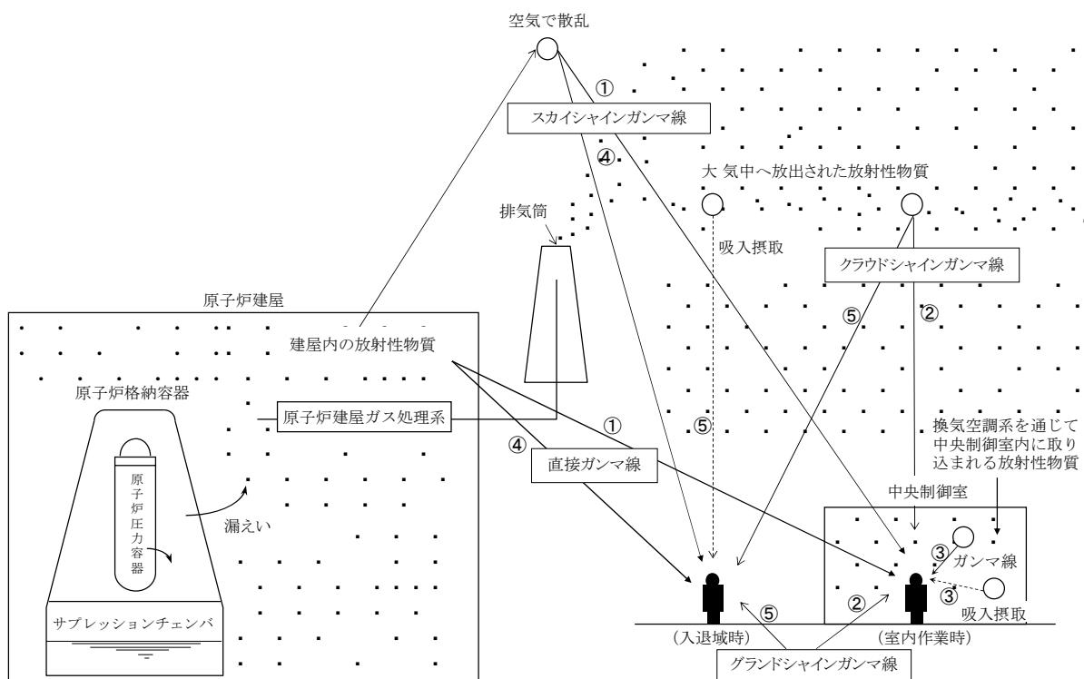
図 4-3 中央制御室の居住性に係る被ばく経路イメージ
