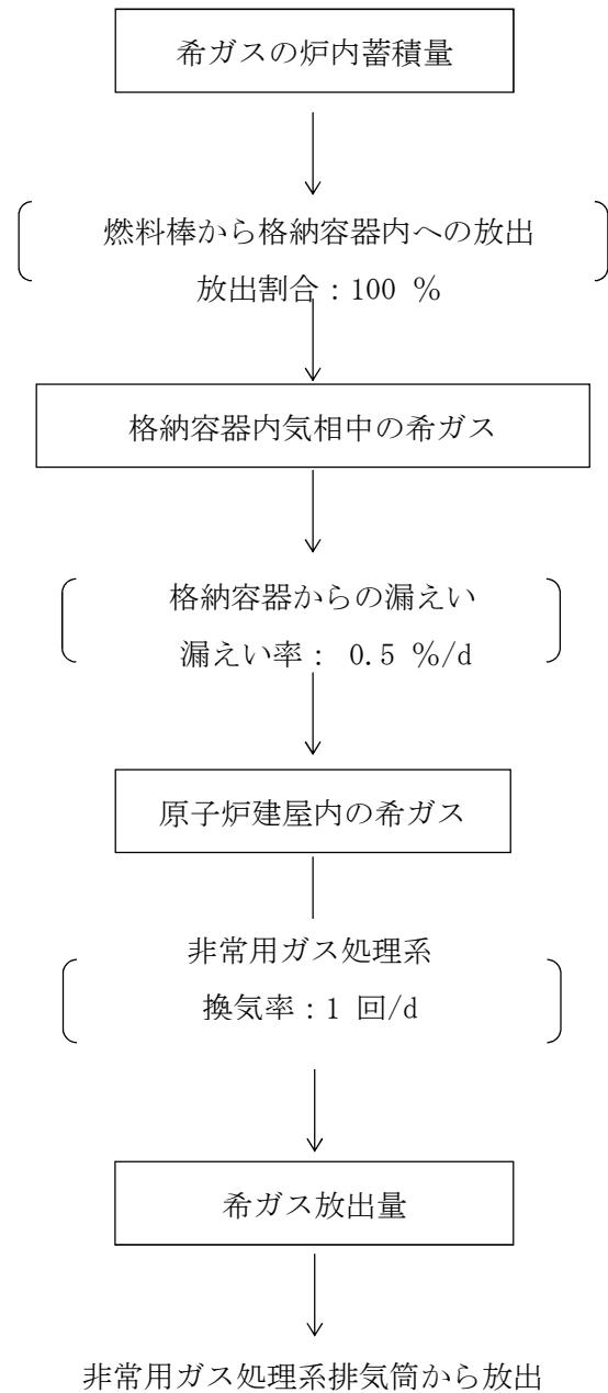
図 4-21 原子炉冷却材喪失時の希ガスの大気放出過程（設計基準事故時）
