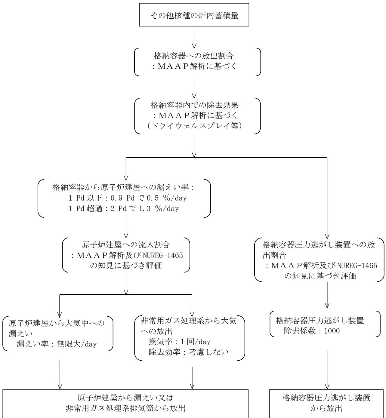
図 4-28 その他核種の大気放出過程（炉心の著しい損傷が発生した場合）
